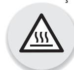
Durante a utilização do aparelho, algumas peças atingem temperaturas elevadas (tampa doseadora, taça em aço inoxidável, tampa, acessórios, cesto de vapor interno e externo). Estas peças podem provocar queimaduras. Manuseie o aparelho utilizando as peças de plástico frias (pega, base).
