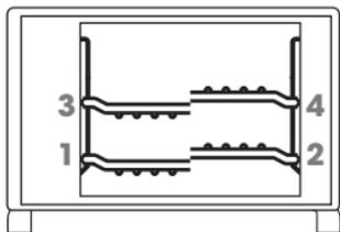
สำหรับการทำงานของเครื่องในทุกระดับชั้น ตำแหน่งของตะแกรงมีความสำคัญต่อการประกอบอาหาร โปรดทราบว่าตำแหน่งของตะแกรงมี 4 ตำแหน่ง วางถาดตรงกลางของตะแกรงในความสูงตามต้องการ
