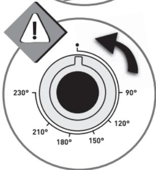
หมุนตัวควบคุมอุณหภูมิไปที่ตำแหน่ง " • "
