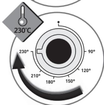
將溫度控制鈕調校至最高溫度。
