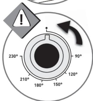
หมุนตัวควบคุมอุณหภูมิไปที่ตำแหน่ง " 0 "
