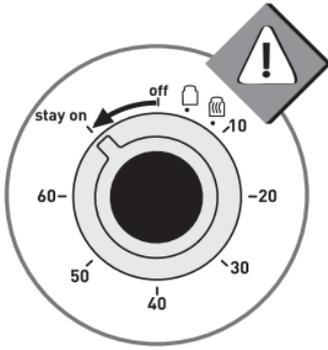
ตั้งตัวตั้งเวลาไปที่ " เปิดค้าง " ไฟแสดงการทำงานสว่าง เครื่องเริ่มอุ่น
