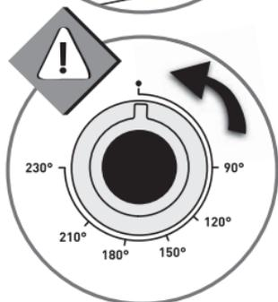
หมุนตัวควบคุมอุณหภูมิไปที่ตำแหน่ง " • "
