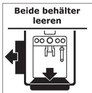
Wenn die Meldung oben angezeigt wird, muss der Abtropfbehälter abgenommen, ausgeleert und gereinigt werden.
