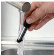
Parní tryska je demontovatelná, aby ji bylo možné kompletně vyčistit. Umývejte ji vodou s přídatkem neabrazivního přípravku na mytí nádobí s pomocí kartáčku. Opláchněte ji a vysušte. Před zpětnou montáží se přesvědčete, že veškeré otvory pro přístup vzduchu nejsou ucpané. Je-li tryska ucpaná, uvolněte ji pomocí jehly.
