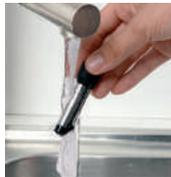
Dyszę pary można rozmontować w celu jej wyczyszczenia. Należy ją myć za pomocą szczoteczki, używając wody z dodatkiem delikatnego środka do mycia naczyń. Splukać wodą i osuszyć. Przed ponownym montażem należy się upewnić, czy wszystkie otwory doprowadzające powietrze są udrożnione i czy nie ma w nich resztek mleka.
