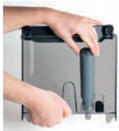
Установка картриджа в прибор. При первом использовании винтите картридж фильтра в дно резервуара для воды
