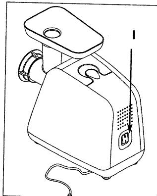
**U slučaju zapušenja:** zaustavite mašnu postavljanjem prekidača na položaj 'O'. Otvorite zatvarač iza koga se nalaze delovi. Pritisnite nekoliko sekundi „reverse“ dugme da bi se oslobođila hrana nakon tогa, posle zatvaranja zatvarača, sa glavnim prekidačem ponovo aktivirajte mašinu kako biste završili mlevenje.
