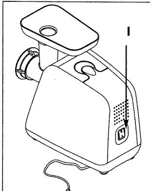
**Ako dođe do začepljenja:** zaustavite stroj za mljevenje tako što ćete sklopku postaviti u položaj "0". Otvorite vratašca za spremanje pribora. Nekoliko sekundi pritisnite i držite sklopku "reverse" kako biste oslobodili namirnice; zatim pritiskom na glavnu sklopku uključite stroj i završite mljevenje nakon što ste zatvorili vratašca.
