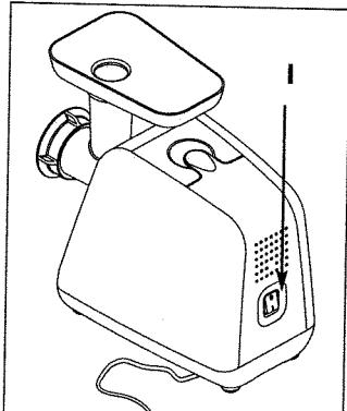
**În caz de blocare:** opriți tocătorul punând întrerupătorul în poziția „0”. Deschideți ușita compartimentului de aranjare a accesoriilor. Apăsați câteva secunde pe întrerupătorul „reverse” pentru a degaja alimentele; puneți apoi în funcțiune apăsând pe întrerupătorul principal pentru a termina tocarea după ce ați închis ușita.
