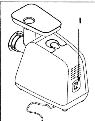
**Če se izdelek zamaši :** ustavite seklijanje tako, da preklopite stikalo na položaj "0". Odprite vratca za zlaganje pripomočkov. Nekaj trenutkov pritisnjajte na stikalo "vzvratno", kar bo sprostilo koščke hrane ; nato vklopite delovanje s pritiskom na glavno stikalo in končajte seklijanje (pred tem je treba zapreti vratca).
