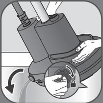
قم بإمالة الجهاز عمودياً لإفراغ المزيج في وعاء. أعد تركيب غطاء التصريف عن طريق لفه بالكامل في اتجاه عقارب الساعة بأصابعك، ولا تستخدم أي أداة.
