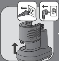
افصل الجهاز عن التيار الكهربائي ثم افصل خزان الماء.
