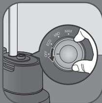
**ES** Gire el botón encender/apagar a la posición "APAGADO" ("OFF"), para apagar el aparato.
