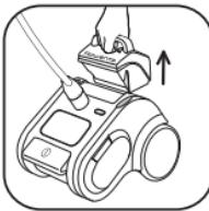
3. Retirez le réservoir de la base et videz l'eau de la chaudière dans un évier par le raccord de tuyau ouvert. Le tartre et les autres résidus sont ainsi évacués.
