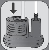
**RU** Вставьте первый сегмент в корпус и вкрутите его вручную до упора.
