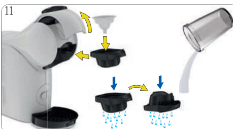
Uklonite posudu. Ispraznite i očistite spremnik. Izvucite držač kapsula. Uklonite uređaj za ispiranje. Držite ga na sigurnom radi kasnijeg čišćenja odnosno uklanjanja kamenca. Isperite obje strane držača kapsula svježom pitkom vodom. Ponovno umetnite držač kapsule.
