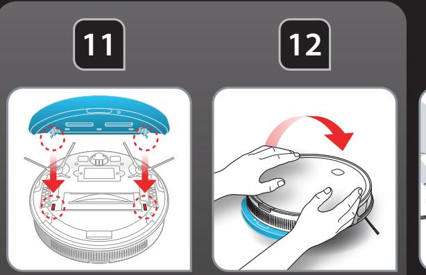
**RU** Закрепите насадку для влажной уборки на пылесосе с помощью двух специальных отверстий.
