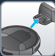
**RU** Для завершения уборки нажмите кнопку на корпусе робота или на пульте ДУ. Чтобы вернуть робота на зарядную станцию, два раза нажмите кнопку на корпусе робота или на пульте ДУ.
