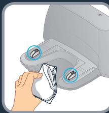
**RU** Очищайте следующие детали мягкой сухой тканью раз в неделю: контактные пластины робота, датчики падения, датчик расстояния и клеммы станции.
