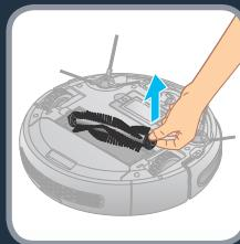
**RU** Очищайте щетку робота раз в неделю. Чтобы извлечь щетку, переверните робот, откройте защелки и выньте крышку щетки.
