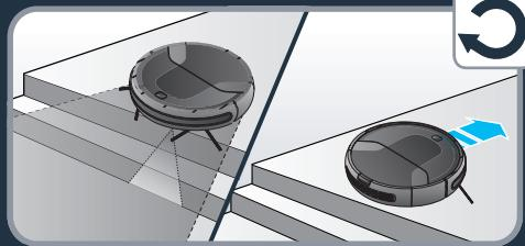
**RU** Робот оснащен датчиками падения для распознавания лестниц и обрывов. Чтобы робот правильно распознавал неровности уровня пола, убедитесь, что на полу рядом с лестницами, ступенями или обрывами отсутствуют какие-либо предметы (сумки, обувь и т. д.).
