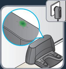
**RU** Подключите блок питания к разъему питания с боковой стороны зарядной станции. Используйте только входящее в комплект зарядное устройство: не пользуйтесь универсальными зарядными устройствами.
