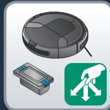
**RU** Внимание! Выключите робот перед извлечением аккумулятора. Для доступа к отсеку аккумулятора, переверните робот, нажмите на защелки отсека и извлеките аккумулятор. Утилизируйте робот и аккумулятор.
