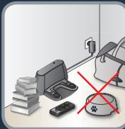
**RU** Устанавливая зарядную станцию, убедитесь, что с каждой стороны пустое пространство составляет 1 м и 2 м перед ней. Не устанавливайте зарядную станцию рядом с лестницей. Убедитесь, что кабель плотно вставлен в соответствующий разъем. Зарядная станция должна быть размещена на твердой поверхности. Не размещайте зарядную станцию на ковровых покрытиях.
