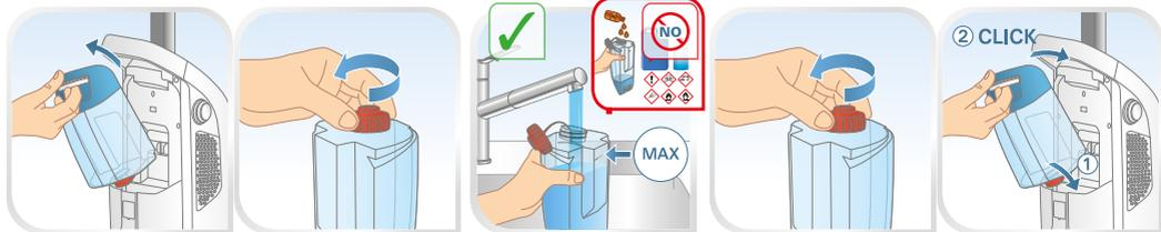
**FR** Remplissez le réservoir d'eau: détachez-le en soulevant la poignée. Dévissez le bouchon et remplissez le réservoir avec de l'eau du robinet. **Attention: ne pas ajouter de produits chimiques, détergents ou parfums.** Revissez le bouchon et replacez le réservoir d'eau sur l'appareil.
