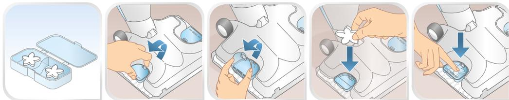
**FR** Utilisation de la pastille à huile essentielle. Avant d'allumer l'appareil, placez la pastille dans l'emplacement prévu à cet effet, puis versez une goutte d'huile essentielle (Ne pas dépasser une goutte d'huile par pastille et par semaine ) directement sur la pastille (attention à ne jamais immerger la pastille). Refermez ensuite le couvercle.
