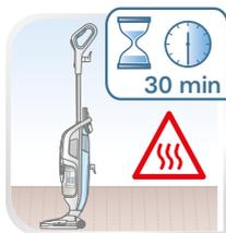
**FR** Videz le réservoir d'eau. Veuillez noter que l'appareil a besoin d'environ 30 minutes pour refroidir.
