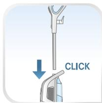
**FR** Branchez la tête sur le corps de l'appareil. Fixez la tête sur le corps de l'appareil. Assemblez le manche au corps du produit.
