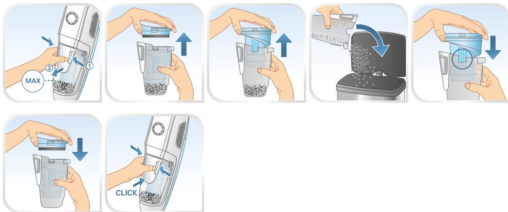
**FR** Pour vider le bac à poussière, appuyez sur les loquets et ôtez-le du corps de l'appareil. Videz le bac et remettez en place les différents éléments : le séparateur puis le couvercle avec son filtre. Réinstallez le bac à poussière sur le corps de l'appareil.
