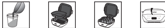
Verser dans les pots en verre Mettre le moule en aluminium dans l'appareil Mettre les pots en verre dans le moule en aluminium Fermer
