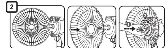
Colocar la malla trasera en su posición de acuerdo con las ilustraciones y enseguida fijar con la tuerca de fijación.
