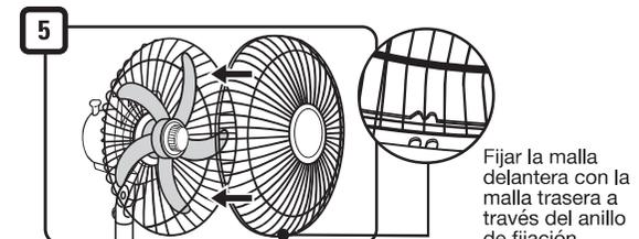
Fijar la malla delantera con la malla trasera a través del anillo de fijación.
