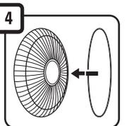
Colocar el anillo para fijación de las mallas en la malla delantera
