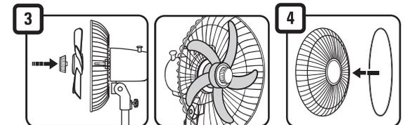
Colocar la hélice en su posición, apretar la tuerca de la hélice girando en el sentido contrario de las agujas del reloj.
