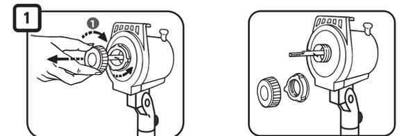
Sacar la tuerca de fijación de las aspas y enseguida la tuerca de fijación de la malla trasera.
