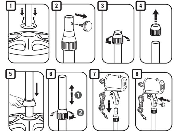
**MONTAJE DE LAS MALLAS - HÉLICE - MOTOR**
