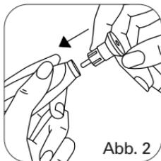
**Achtung!** Achten Sie stets darauf, den Gerätestecker zu ziehen, wenn Sie die Aufsätze aufstecken, lassen Sie ferner die Aufsatzteile korrekt in Ihrem Sitz einrasten (den Aufsatz andrücken, bis Sie einen Widerstand spüren (Abb. 2).
