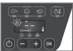
**11** Het gekozen programma blijft aan de bovenkant van het scherm weergegeven. Druk op de “-“ en “+“ knop om het gewenste bakniveau (weinig, medium of goed doorbakken) te selecteren. Eenmaal u het gewenste bakniveau hebt bereikt, druk op de “OK/START” knop. Het gekozen bakniveau blijft aan de onderkant van het scherm weergegeven.
