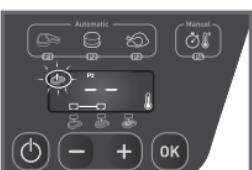
**12** Wenn das Vorheizen abgeschlossen ist, ertönt ein Signalton und das Thermometer sowie 3 Strichzeilen hören auf zu blitzen. Darüber hinaus erscheint das Symbol für „Grillgut auflegen“ links im Display. Das Thermometer wird während des gesamten Grillvorgangs kontinuierlich angezeigt, um darauf hinzuweisen, dass das Gerät in Betrieb und heiß ist.
