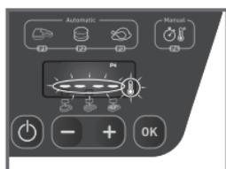
25 Pulse los botones “-” y “+” para seleccionar el tiempo de cocción. Confirme presionando “OK/START”.
