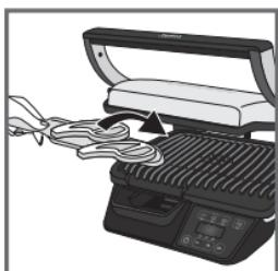
27-28 Una vez precalentado, el aparato está listo para usar. Abra el grill y coloque los alimentos en la placa de cocción.
