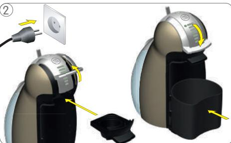
Otevřete zavírací páku a vložte prázdný držák
