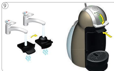
Držák na kapsle vypláchněte vodou z obou stran a vysušte jej. Vložte držák kapslí do přístroje. Vychutnejte si nápoj!
