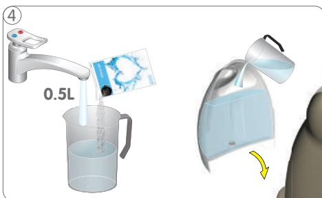
Smíchejte v odměrce 0,5 litr čisté pitné vody se sáčkem odvápnovacího přípravku.
