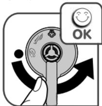
Veillez à ne pas appuyer verticalement sur la soupape de fonctionnement lors de la décompression.
