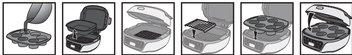
Ulijte u kalup Izvadite aluminijsku posudu Provjerite je li cm reflektor topline propisno umetnut i pričvršćen na dno uređaja. Stavite rešetku na reflektor topline* Stavite kalup Zatvorite
