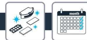
**PT** Limpe a grelha do filtro e o filtro, batendo ligeiramente na parte traseira por cima de um caixote do lixo. Lave o filtro de espuma, grelha do filtro e recipiente de poeiras com água limpa. Não molhe o filtro do pó fino (filtro branco). Os filtros devem ser limpos, pelo menos, uma vez por semana.
