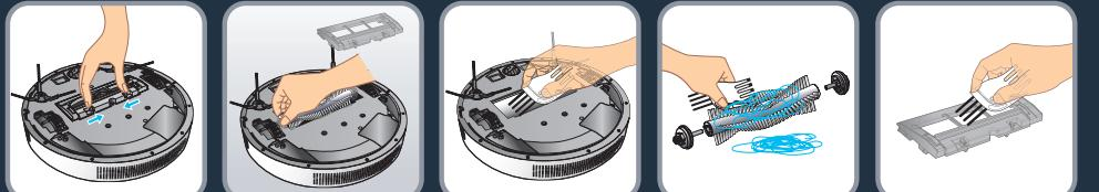
**RU** Чтобы очистить центральную щетку, сдвиньте защелки в сторону центра и поднимите крышку. Возьмитесь за центральную щетку и извлеките ее. Очистите компоненты с помощью специальной щетки. Регулярно удаляйте с центральной щетки волосы и другие запутавшиеся предметы.
