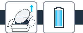
**TR** Robotu şarj etmek için robotu şarj istasyonuna yerleştirin: robotun üzerindeki şarj plakaları, şarj istasyonundaki ile temas etmelidir. Robot şarj olurken makinenin şarj ışığı mavi renkte yanıp söner; robot tamamen şarj olduğunda tamamen mavi renkte yanar.
