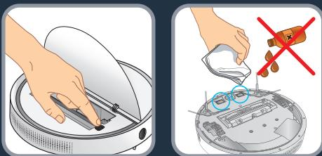
**RU** Чтобы очистить контактные пластины, откройте откидывающуюся крышку и отключите робот с помощью выключателя (или отключите шнур питания). Протрите пластины сухой тканью. Не протирайте пластины веществами, имеющими в своем составе масло. Очищайте контактные пластины один раз в месяц.
