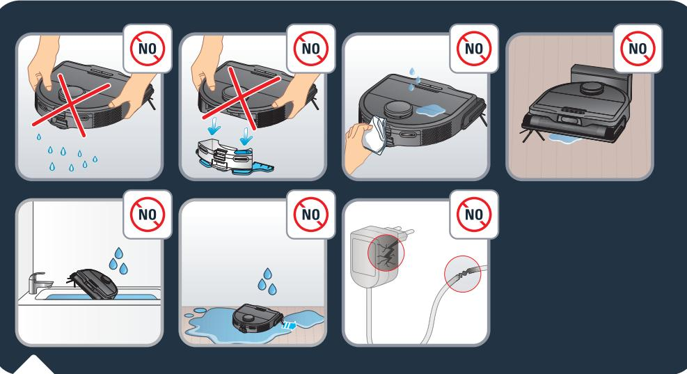
Robot nemojte tresti. Vibrirajući nosač krpe nemojte pokušati skinuti sa spremnika za vodu. Na robot nemojte stavljati vodu ni vlažnu krpnu. Robot nemojte puniti kada je pod poplavljjen. Robot nemojte uranjati u vodu. Robot nemojte upotrebljavati na vlažnim površinama ili površinama na kojima se zadržava voda.
