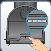
Для використання робота без функції прибирання (режим «лише пилосос»), установіть модуль «лише пилосос» ззаду робота. Якщо ви почули звук клацання, модуль встановлено правильно. Щоб розпочати прибирання, натисніть кнопку пуску або скористайтеся програмою. Якщо ви не використовуєте функцію миття, тримайте встановленим у робота модуль «лише пилосос». Модуль «лише пилосос» має зарядні пластини, щоб робот міг під'єднатися до станції та зарядити акумулятор.
