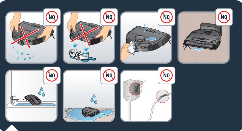
Ne rázza a robotot. Ne próbálja meg leszerelni a rezgő felmosótartót a víztartályról. Ne tegyen vizet vagy nedves ruhát a robotra. Ne töltse a robotot, ha a talaj el van árasztvavízzel. Ne merítse a robotot vízbe. Ne használja a robotot nedves felületen vagy vízzel borított felületen.
