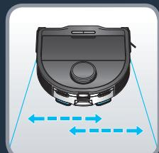
A „csak porszívó” modul kiszereléséhez válassza le a „csak porszívó” modult a retesz megnyomásával és kihúzásával. Vegye ki a víztartályt, és rögzítse a robot hátulján. A víztartály akkor van megfelelően behelyezve, ha kattanást hall. A tisztítás megkezdéséhez nyomja meg az « Indítás » gombot, vagy használja az alkalmazást. A rezgő felmosótartó automatikusan aktiválódik a balról jobbra történő mozgatással.
