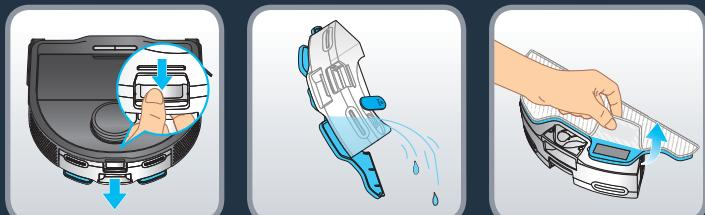
Na koncu čiščenja odpnite rezervoar za vodo s pritiskom na zapah in povlecite, da odstranite rezervoar za vodo. Iz rezervoarja za vodo izpraznite preostalo vodo. Odstranite umazano krpou za brisanje.
