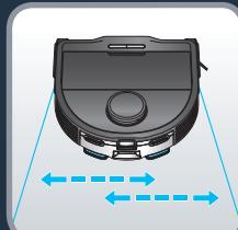
Від'єднайте модуль «лише пилосос», натиснувши на фіксатор, і потягніть, щоб зняти його. Візьміть резервуар для води та закріпіть його ззаду робота. Якщо ви почули звук клацання, резервуар для води встановлено правильно. Щоб розпочати прибирання, натисніть кнопку пуску або скористайтесь програмою. Вібраційна насадка для шабри автоматично активується рухом зліва направо.
