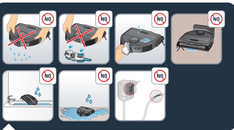
Nepokúšajte sa oddeliť vibrujúci držiak na mop od zásobníka vody. Nekladte vlhkú tkaninu ani tekutiny na robot. Robot nenabíjajte, keď je zem zatopená. Neponárajte robot do vody. Robot nepoužívajte na vlhkých povrchoch alebo povrchoch so stojacou vodou.
