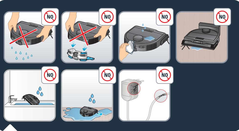
Μην ανακινείτε το ρομπότ. Μην επιχειρείτε να αποσυναρμογήσετε τον δονούμενο βραχίονα σφουγγαρόπανου από το δοχείο νερού. Μην τοποθετείτε νερό ή οποιουδήποτε τύπου υγρό πανί στο ρομπότ. Μην φορτίζετε το ρομπότ όταν το έδαφος είναι πλημμυρισμένο. Μην βυθίζετε το ρομπότ σε νερό. Μην χρησιμοποιείτε το ρομπότ σε υγρές επιφάνειες ή επιφάνειες με λιμνάζον νερό.
