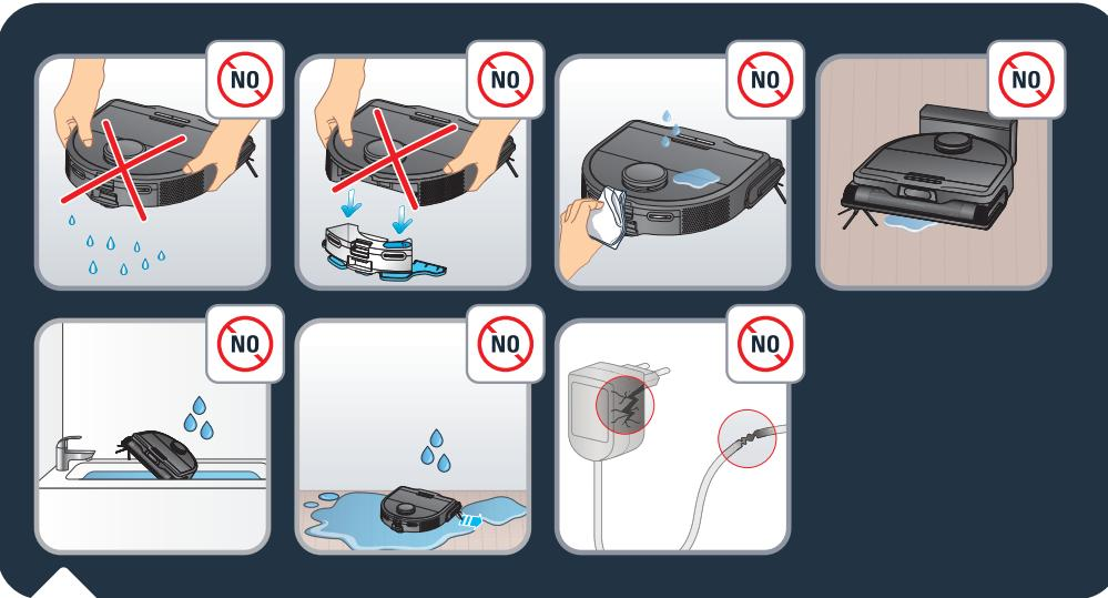
Sesalnika ne stresajte. Vibrirajočega nosilca krpe ne poskušajte razstaviti iz rezervoarja za vodo. Na sesalnik ne postavljajte vode ali mokre krpe. Ne polnite sesalnika, če so tla poplavljena. Sesalnika ne potapljamte v vodo. Sesalnika ne uporabljajte na mokrih površinah ali površinah s stoječo vodo.
