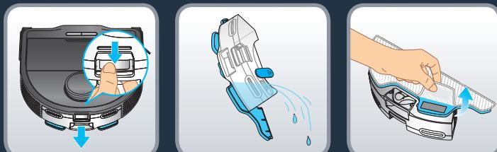
Na kraju sesije čišćenja izvadite spremnik za vodu tako da pritisnete bravicu i izvučete i uklonite spremnik za vodu. Ispraznite ostatak vode iz spremnika za vodu. Skinite prljavu krpu za brisanje.
