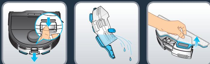
Na kraju sesije čišćenja, otkačite spremnik za vodu pritiskom na rezu i povucite da uklonite spremnik za vodu. Ispraznite spremnik za vodu od preostale vode. Uklonite prljavu krpu za brisanje.
