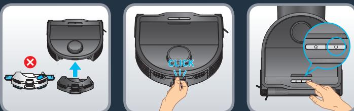
Jestliže chcete robota používat bez funkce mopování (režim „pouze vysavač“), nainstalujte na zadní stranu robota modul „pouze vysavač“. Aby byl modul správně nainstalovaný, musí se ozvat „cvaknuli“. Úklid zahájte stisknutím tlačítka „Start“ nebo pomocí aplikace. Jestliže nepoužíváte funkci mopování, nechte v robotovi nainstalovaný režim „pouze vysavač“. Modul „pouze vysavač“ je vybaven nabíjecími kontakty, které robotovi umožňují zadokovat do stanice a nabít si baterii.
