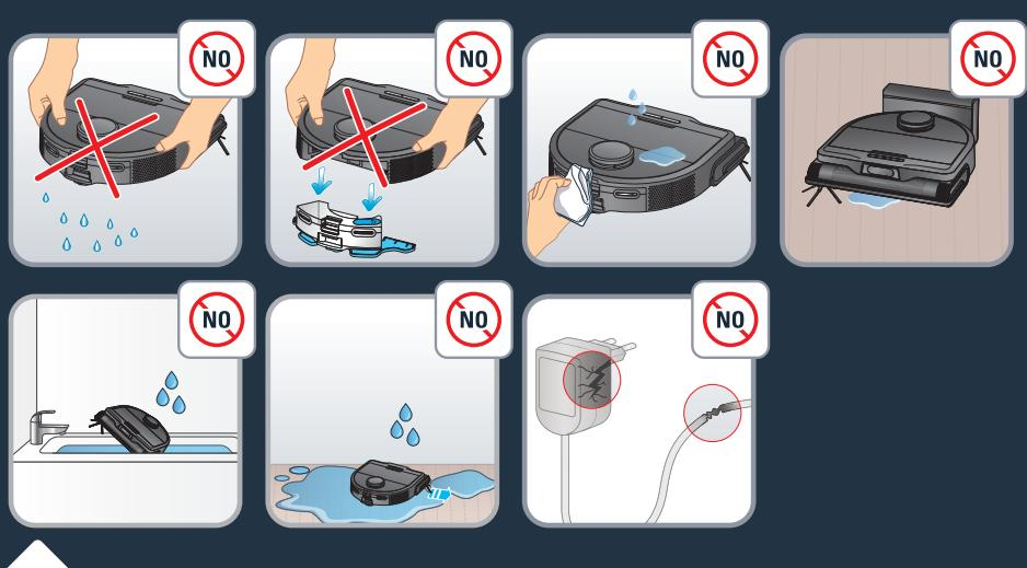
Не трясіть робота. Не намагайтесь від'єднати вібраційну насадку для мопу від резервуара для води. Не ставте на робота воду або будь-яку мокру тканину. Не заряджайте робота, коли поверхня затоплена водою. Не занурюйте робота у воду. Не використовуйте робота на мокрих поверхнях або поверхнях з калюжами води.
