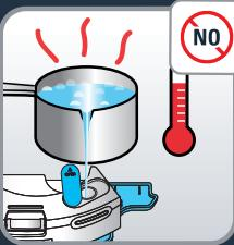
Otvorite zatvarač rezervoara za vodu i napunite ga čistom vodom dok rezervoar za vodu ne bude pun. Ne koristite vruću vodu. Upozorenje: nemojte dodavati sredstva za čišćenje u rezervoar za vodu.
