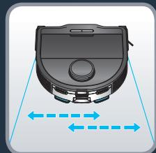
Odvojite modul „Samo usisavanje“ tako da pritisnete bravicu i izvučete i uklonite modul „Samo usisavanje“. Uzmite spremnik za vodu i pričvrstite ga na stražnju stranu robota. Spremnik za vodu pravilno je umetnut kada začujete klik. Pritisnite tipku « Pokreni » ili upotrijebite aplikaciju za pokretanje čišćenja. Vibrirajući nosač krpe automatski će se aktivirati pokretom slijeva udesno.
