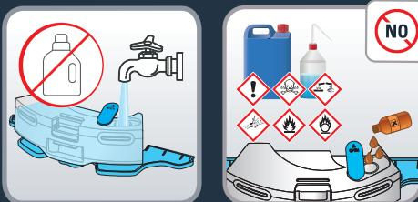
Otvorite čep spremnika za vodu i napunite spremnik za vodu čistom vodom. Nemojte koristiti vruću vodu. Upozorenje: Nemojte dodavati sredstva za čišćenje u spremnik za vodu. To može začepiti cijevi i uzrokovati da spremnik za vodu više ne radi.
