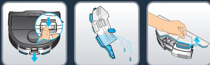
Kada se završi čišćenje, odvojite rezervoar za vodu tako što ćete pritisnuti rezu i povući da izvadite rezervoar za vodu. Ispraznite rezervoar za vodu od preostale vode. Izvadite prljavu krpu za brisanje.
