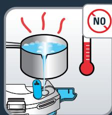
Nyissa ki a víztartály ütközőjét, és töltse fel tiszta vizet, amíg a víztartály meg nem telik. Ne használjon forró vizet. Figyelem: Ne töltsön tisztítószeret a víztartályba. Ez eltömítheti a csöveget, és a víztartály nem fog működni.
