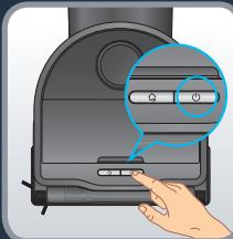
Da biste koristili robot bez funkcije pranja (način „Samo usisavanje“), postavite modul „Samo usisavanje“ na stražnju stranu robota. Modul je pravilno umetnut kada začujete klik. Pritisnite tipku « Pokreni » ili upotrijebite aplikaciju za pokretanje čišćenja. Modul „Samo usisavanje“ ostavite u robotu kada ne upotrebljavate funkciju pranja. Modul „Samo usisavanje“ ima kontakte za punjenje koji omogućuju robotu da se priključi na stanicu i napuni bateriju.
