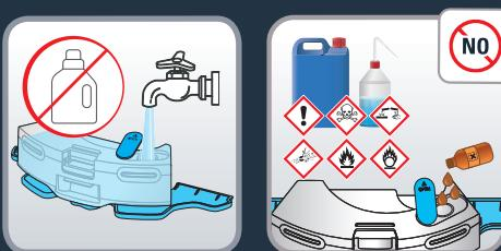
Otvorte vrchnák zásobníka vody a naplňte ho doplnia čistou vodou. Nepoužívajte horúcu vodu. Varovanie: Do zásobníka vody nepridávajte čistiace prostriedky. Môžu sa upchať potrubia a zásobník na vodu prestane fungovať.
