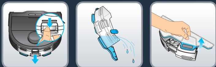
Наприкінці сеансу прибирання від'єднайте резервуар для води, натиснувши на фіксатор, і потягніть, щоб зняти його. Злийте залишки води з резервуара для води. Зніміть брудний моп.
