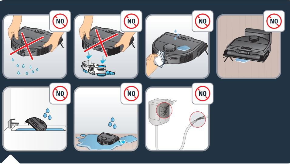
Robotem netřeste. Nepokoušejte se demontovat vibrační držák mopu od nádržky na vodu. Nepokládejte na robota vodu ani žádnou mokrou látku. Nenabíjejte robota, když na podlaze stojí voda. Neponořujte robota do vody. Nepoužívejte robota na vlhkých površích nebo na površích, kde stojí voda.
