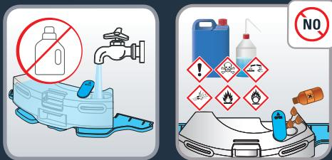
Odprite zamašek rezervoarja za vodo in ga napolnite s čisto vodo, dokler ni rezervoar za vodo poln. Ne uporabljajte vroče vode. Opozorilo: Ne dodajajte čistilnih sredstev v vodni rezervoar.
