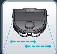
Odvojite modul „samo usisavanje“ tako što ćete pritisnuti rezu i povući da izvadite modul „samo usisavanje“. Uzmite rezervoar za vodu i prikačite ga na zadnji deo robota. Rezervoar za vodu je ispravno postavljen kada čujete zvuk „škljocanja“. Pritisnite dugme „Pokreni“ ili koristite aplikaciju da započnete čišćenje. Nosač vibrirajućeg brisača će se automatski aktivirati kretanjem levo-desno.
