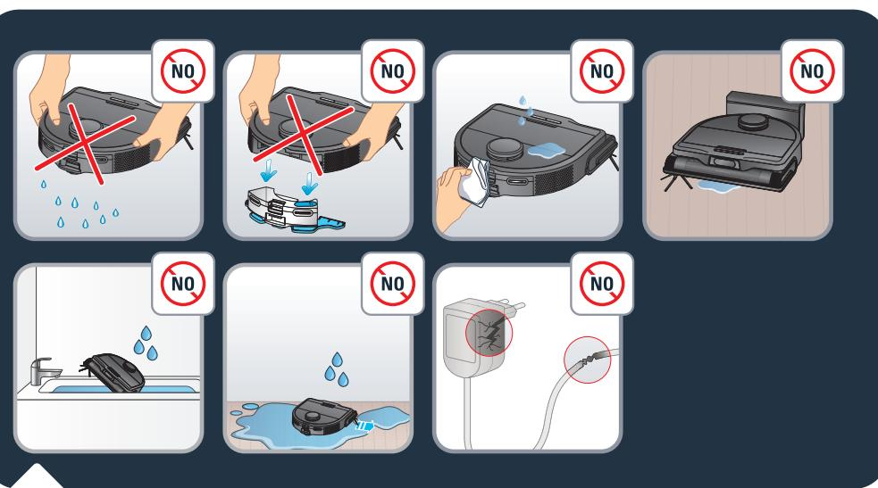
Nemojte tresti robota. Ne pokušavajte rastaviti vibrirajući držač krpe za brisanje na spremniku za vodu. Nemojte stavljati vodu ili bilo kakvu mokru krpu na robota. Nemojte puniti robota kada je pod poplavljen. Ne uranajte robota u vodu. Nemojte koristiti robota na mokrim površinama ili površinama sa stajaćom vodom.
