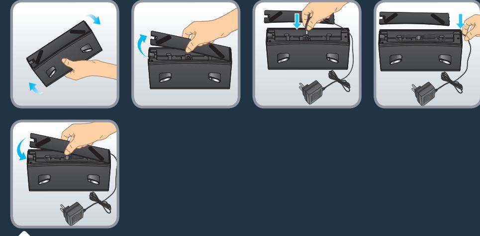
Îndepărtați capacul inferior al stației de încărcare și conectați adaptorul. Acordați atenție aranjării cablului de conectare al adaptorului pentru a evita agățarea în timpul aspirării. Punetă la loc capacul inferior.
