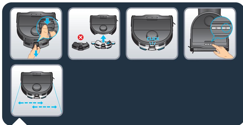
Desprindeți modulul „doar aspirat” apăsând pe prindere și trageți-l pentru a-l scoate. Luați rezervorul de apă și prindeți-l în partea din spate a robotului. Rezervorul de apă este montat corect când auziți un clic. Apăsați butonul „Start” sau folosiți aplicația pentru a începe curățenia. Suportul vibrator de mop va fi activat automat cu o mișcare de la dreapta la stânga.
