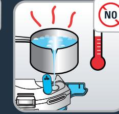
Deschideți opritorul de la rezervorul de apă și umpleți rezervorul cu apă. Nu folosiți apă caldă. Avertisment: Nu adăugați detergenti în rezervorul de apă.
