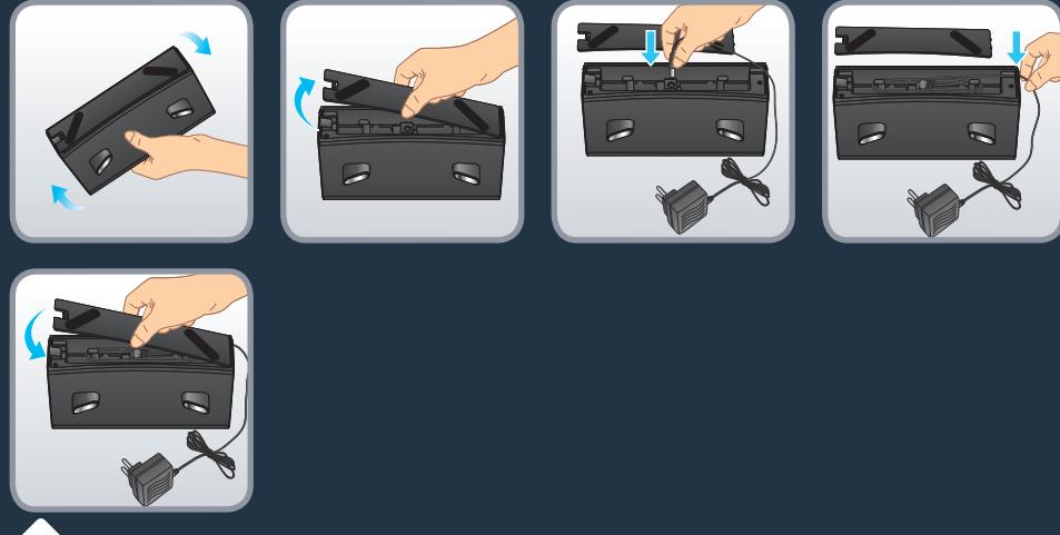
Retournez la station. Retirez le couvercle inférieur de la station d'accueil et connectez l'adaptateur. Veillez à disposer le câble de connexion de l'adaptateur de manière à éviter qu'il s'enroule pendant le balayage. Remettez le couvercle inférieur en place.
