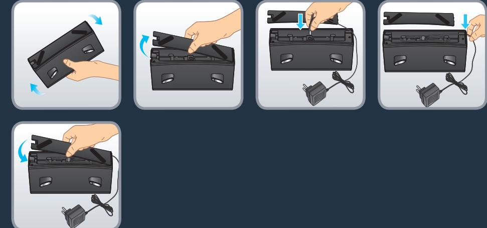
Retire a tampa inferior da estação de base e ligue o transformador. Preste atenção à disposição do fio de ligação do transformador para evitar que se enrolle durante a limpeza. Volte a colocar a tampa inferior.
