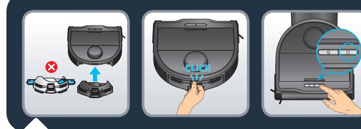
Pentru a folosi robotul fără funcția de șters pe jos (modul „doar aspirat”), instalați-i în partea din spate modulul „doar aspirat”. Modulul este montat corect când auziți un clic. Apăsați butonul „Start” sau folosiți aplicația pentru a începe curățenia. Păstrați modul „doar aspirat” instalat în robot când nu folosiți funcția de șters pe jos. Modulul „doar aspirat” este echipat cu contacte de încărcare, care îi permit robotului să se conecteze la stație și să-și încarce bateria.
