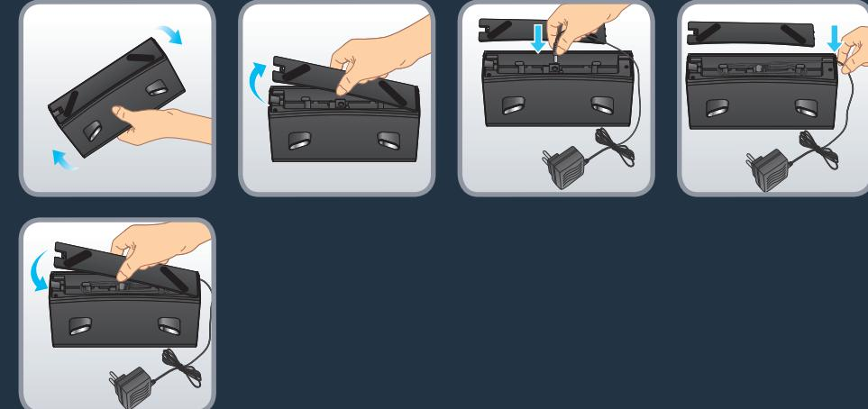
Verwijder de onderklep van het dockingstation en sluit de adapter aan. Let erop dat u het aansluitsnoer van de adapter zo geleidt dat deze niet in de war raakt tijdens het reinigen. Plaats het onderste deksel terug.
