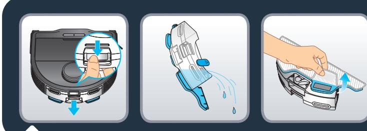
No final da sessão de limpeza, liberte o depósito de água pressionando o trinco e puxe para remover o depósito de água. Esvazie o depósito de água. Retire o pano sujo da mopa.
