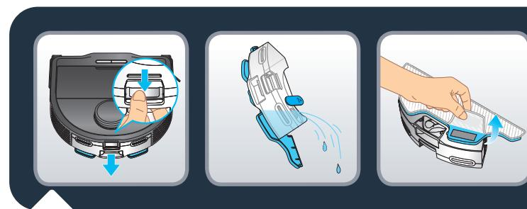
Al termine della sessione di pulizia, sganciare il serbatoio dell'acqua premendo il fermo e tirandolo per rimuoverlo. Svuotare il serbatoio eliminando l'acqua residua. Rimuovere il panno mop sporco.
