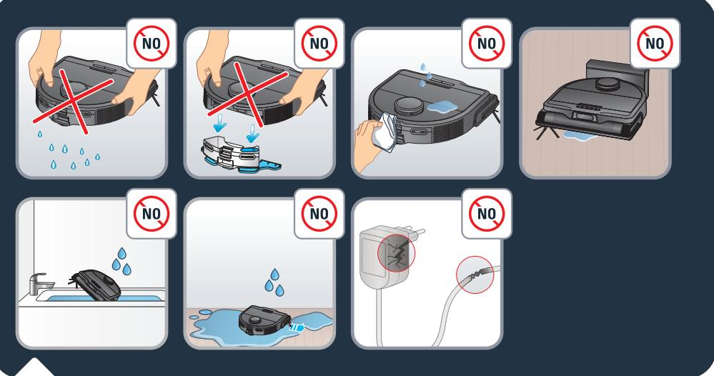
Schud de robot niet. Probeer niet de vibrerende dweilsteen van het waterreservoir te demonteren. Plaats geen water of natte doek op de robot. Laad de robot niet op wanneer de vloer onder water staat. Dompel de robot niet onder in water. Gebruik de robot niet op natte oppervlakken of oppervlakken waar water op staat.
