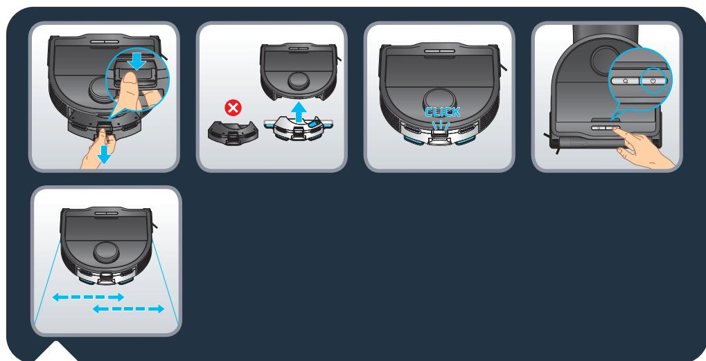
Liberte o módulo “aspiração” premindo o trinco e puxando para retirar o módulo “aspiração”. Encaixe o módulo “aspiração e limpeza” na parte de trás do robot. O módulo “aspiração e limpeza” estará corretamente instalado quando ouvir um “clique”. Prima o botão “Iniciar” ou utilize a app para iniciar a limpeza. O suporte de mopa oscilante será automaticamente ativado com um movimento da esquerda para a direita.
