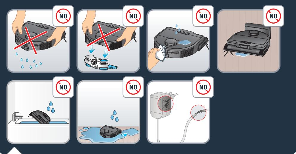
Nu scuturați robotul. Nu încercați să desprindeți suportul vibrator de mop de pe rezervorul de apă. Nu puneți apă sau cârpe ude pe robot. Nu încărcați robotul când solul este inundat. Nu scufundați robotul în apă. Nu folosiți robotul pe suprafete ude sau pe suprafete unde apa bâltește.
