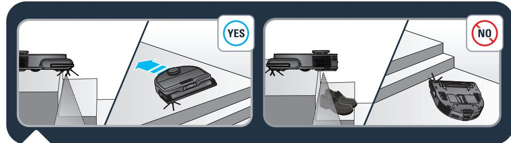
O robot tem sensores antiqueda para detetar escadas. O robot muda de direção quando as deteta. Para uma melhor eficiência dos sensores antiqueda, retire qualquer objeto (por ex., sapatos) das escadas. Ao utilizar o robot numa área elevada, coloque uma barreira física na extremidade de um desnível para evitar quedas accidentais.
