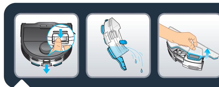
Al final de la sesión de limpieza, desengancha el depósito de agua; para ello, tira del pasador y extrae el depósito de agua. Vacía el agua que pueda quedar en el depósito. Quita la mopa sucia.
