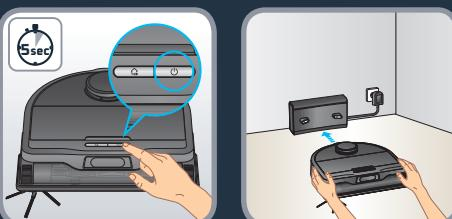
Porniți robotul ținând apăsat butonul START până când luminile se aprind (cca. 5 secunde). Așezați manual robotul lipit de stație. Așteptați 3-4 ore pentru ca robotul să se încarce complet. Când faceți curat pentru prima dată, asigurați-vă că robotul este încărcat complet. Când faceți curat prima dată într-un mediu nou, robotul va crea harta locuinței. Pentru a spori precizia hărții, în robot trebuie să fie instalat modulul „doar aspirat”, nu rezervorul de apă vibrator.
