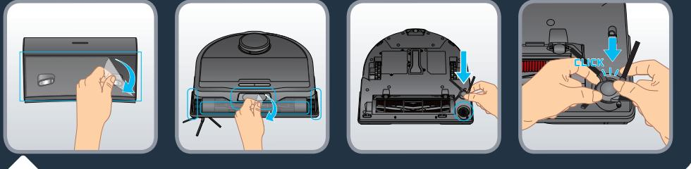
Verwijder al het beschermende materiaal (beschermfolie) van het station en de robot. Draai de robot om, installeer de zijborstel door deze voorzichtig vast te klikken. De zijborstel is correct geplaatst wanneer u een klik hoort.
