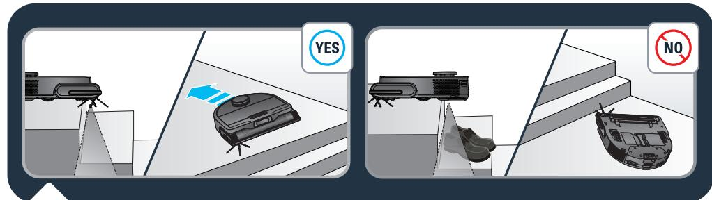
Le robot est équipé de capteurs de chute pour détecter les escaliers. Le robot change de direction lorsqu'il les détecte. Pour une efficacité optimale des capteurs de chute, retirez tout élément (par ex. les chaussures) des escaliers. Lorsque vous utilisez le robot dans une zone surélevée, placez une barrière physique en bordure de la zone pour éviter les chutes accidentnelles.
