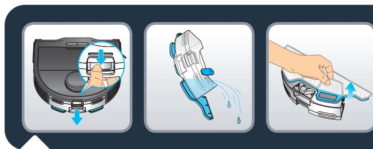
À la fin de la séance de nettoyage, déclipsez le réservoir d'eau en appuyant sur le loquet et en tirant pour le retirer. Videz l'eau qui reste dans le réservoir. Retirez la serpillière sale.
