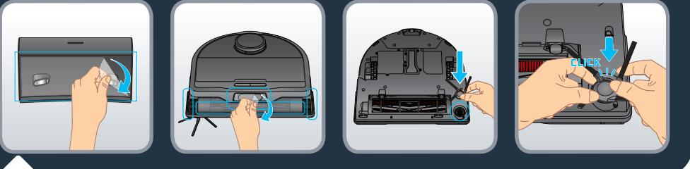
Retira todas las protecciones (plásticos protectores) de la base y del robot. Da la vuelta al robot e instala el cepillo lateral acoplándolo suavemente. El cepillo lateral está instalado correctamente cuando se escucha un clic.
