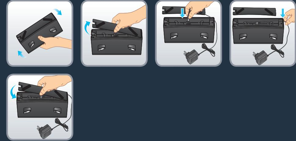
Rimuovere il coperchio inferiore della base di ricarica e collegare l'adattatore. Assicurarsi di disporre il cavo di collegamento dell'adattatore in modo da evitare grovigli durante le operazioni di pulizia. Riposizionare il coperchio inferiore.
