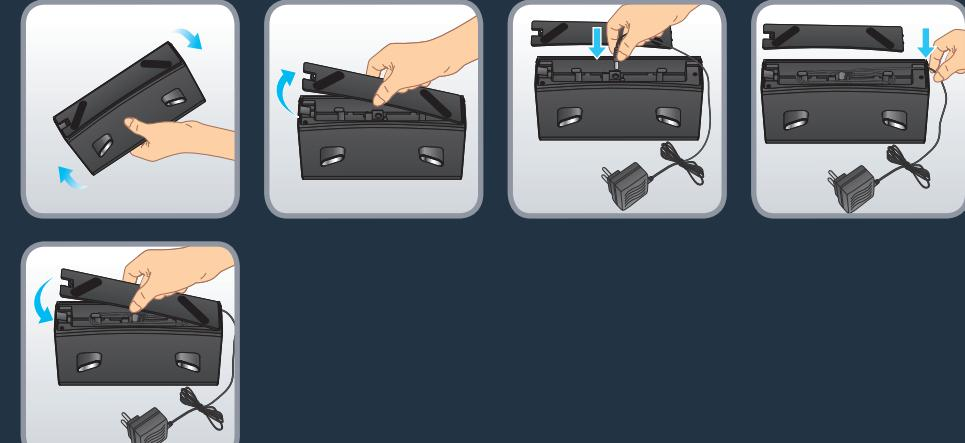
Entfernen Sie die untere Abdeckung der Docking-Station und schließen Sie den Adapter an. Achten Sie darauf, dass das Anschlusskabel des Adapters während des Saugens nicht aufgewickelt wird. Bringen Sie die untere Abdeckung wieder an.
