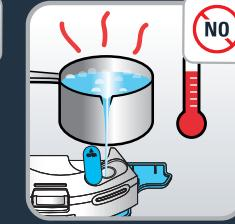
Abre el tapón del depósito de agua y llénalo hasta arriba con agua limpia. No utilices agua caliente. Advertencia: No añadas agentes de limpieza en el depósito de agua. Esto puede atascar las tuberías y provocar que el depósito de agua deje de funcionar.
