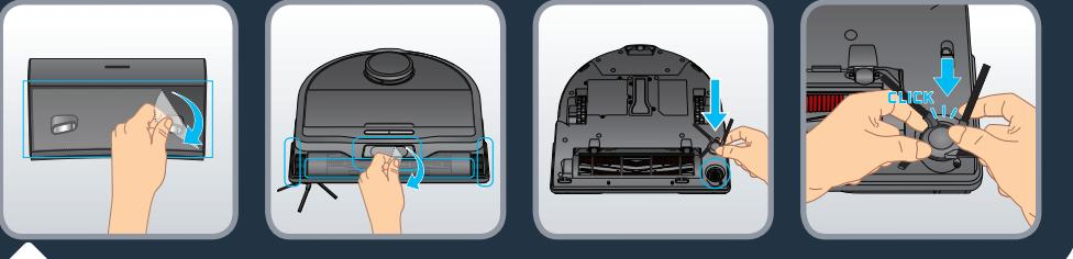
Rimuovere tutte le protezioni (pellicole protettive) sulla stazione e sul robot. Capovolgere il robot e installare la spazzola laterale agganciandola delicatamente. La spazzola laterale è installata correttamente quando si sente uno scatto.
