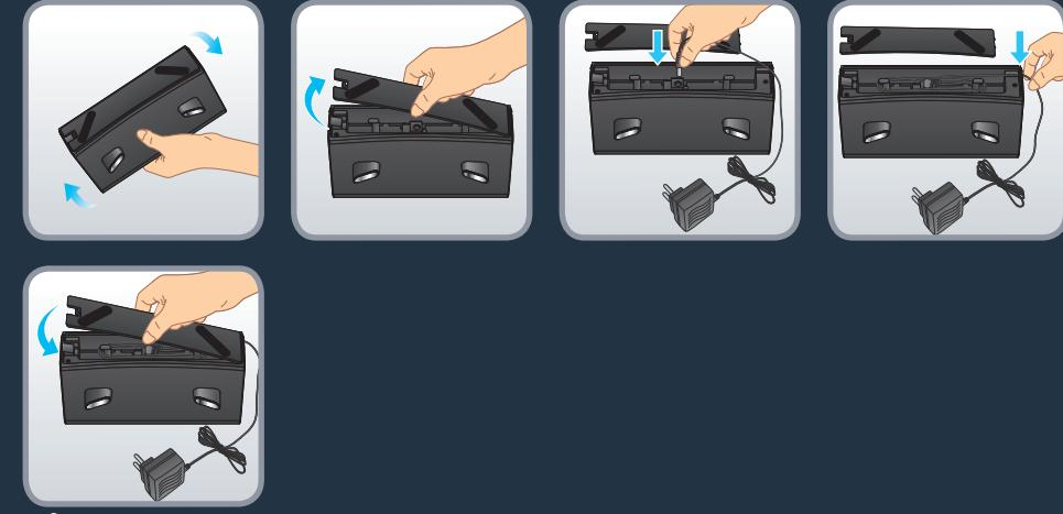
Retira la cubierta inferior de la base de carga y conecta el adaptador. Presta atención a la disposición del cable de conexión del adaptador para evitar que se enrolle durante la aspiración. Vuelve a colocar la cubierta inferior.
