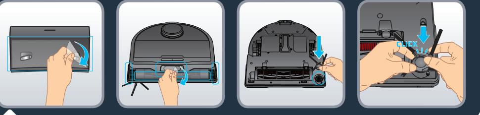
Entfernen Sie alle Schutzfolien an der Station und am Roboter. Drehen Sie den Roboter um und bringen Sie die Seitenbürste vorsichtig an, sodass sie einrastet. Die Seitenbürste ist korrekt angebracht, wenn Sie ein Klickgeräusch hören.
