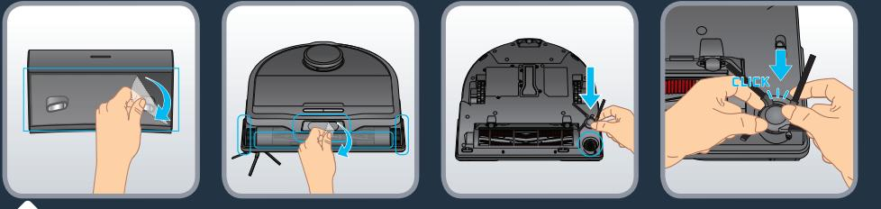
Scoateți toate protecțiile (foliile de protecție) de pe stație și de pe robot. Întoarceți robotul și montați peria laterală prințând-o cu grijă. Peria laterală este montată corect când auziți un clic.
