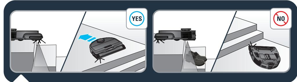
Robotul are senzori anti-cădere pentru a detecta scările. Robotul își va schimba direcția când le va detecta. Pentru o eficiență optimă a senzorilor anti-cădere, luați toate obiectele (de ex. pantofii) de pe scări. Când folosiți robotul într-o zonă înălțată, puneți o barieră fizică pe margine, pentru a preveni căderile accidentale.
