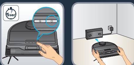
Ligue o robot ao manter premido o botão INICIAR até as luzes do robot se acenderem (cerca de 5 segundos). Coloque manualmente o robot na base. Aguarde 3-4 horas para que o robot esteja totalmente carregado. Para a primeira limpeza, certifique-se de que o robot está totalmente carregado. Para a primeira limpeza num ambiente novo, o robot irá criar um mapa da casa. Para melhorar a precisão do mapa, não utilize o reservatório de água oscilante e mantenha o módulo "aspiração" instalado no robot.
