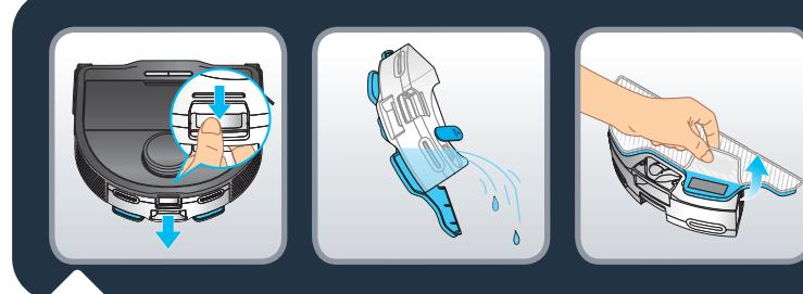
Maak aan het einde van de reinigingssessie het waterreservoir los door op de vergrendeling te drukken en te trekken om het waterreservoir te verwijderen. Leeg het waterreservoir. Verwijder de vuile dweil.
