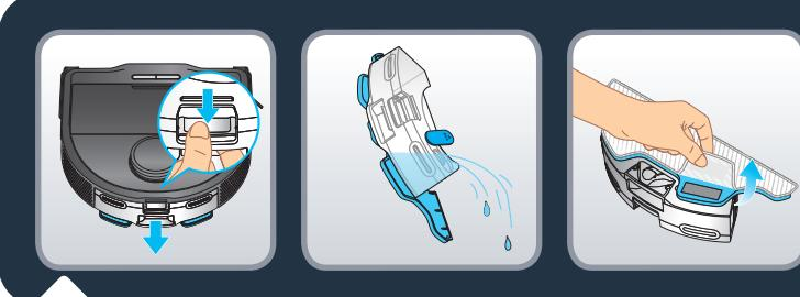
Lösen Sie am Ende der Reinigung den Verschluss des Wassertanks, indem Sie die Lasche drücken, und ziehen Sie am Tank, um ihn zu entfernen. Leeren Sie das restliche Wasser aus dem Wassertank. Entfernen Sie das verschmutzte Wischtuch.
