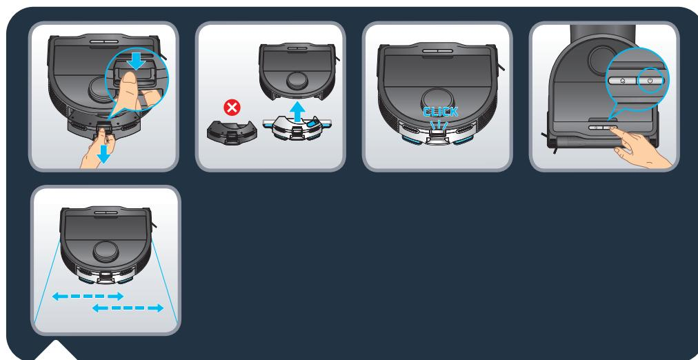
Pulsa el seguro y tira del módulo "Solo aspirador" para extraerlo. Acopla el depósito de agua a la parte posterior del robot. El depósito de agua está instalado correctamente cuando se escucha un clic. Pulsa el botón para iniciar o utiliza la aplicación para comenzar la limpieza. El soporte para mopa vibratorio se activará automáticamente con un movimiento de izquierda a derecha.
