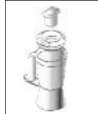
1. Pogonsko vreteno suda za miksanje postavite na kućište motora. Uglavite ga pomoću okretaja suprotog od smera kazaljki na satu.
