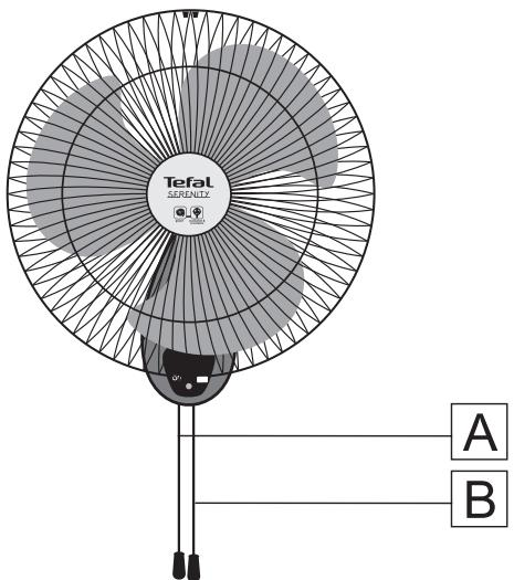
Kéo dây **A** sử dụng hệ thống chuyển hướng
