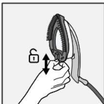
**FR** Avant de retirer ou d'attacher la brosse, éteignez l'appareil et laissez-le refroidir pendant 1 heure. Placez la brosse à vapeur sur la semelle du fer à repasser. Cet accessoire aide à ouvrir les fibres du vêtement pour une meilleure pénétration de la vapeur.
