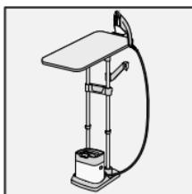
**FR** Placez la table à l'horizontale et positionnez le fer à repasser et son repose-fer sur le crochet de cintre. Pour le déverrouiller, appuyez sur la languette située dans le crochet de cintre.
