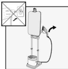
**FR** Déverrouillez ce repose-fer en appuyant sur la languette plastique à l'intérieur. Retirez le repose-fer avec le fer à repasser.
