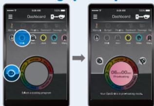
14 U kunt de bereiding naar uw voorkeur aanpassen door een bereidingsmodus te selecteren en de profielen op de gewenste bakniveaus te plaatsen. Druk op het profiel om het op het wiel te plaatsen. Verplaats het dan door het met uw vinger te slepen. Een profiel kan op ieder moment worden toegevoegd en geplaatst. Druk op "OK" op uw OptiGrill om de voorverwarming te starten. Volg de stappen op de applicatie om de bereiding te starten.
