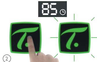
② Taste „TEA MASTER“ drücken. Tee wird zubereitet. Im Display wird die verbleibende Zeit in Sekunden angezeigt und die Taste „TEA MASTER“ blinkt grün.
