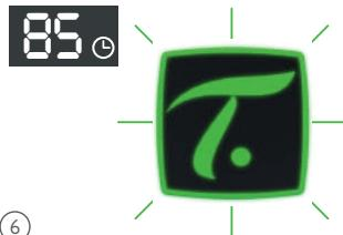
⑥ Tee wird zubereitet. Im Display wird die verbleibende Zeit in Sekunden angezeigt und die Taste "TEA MASTER" blinkt grün.
