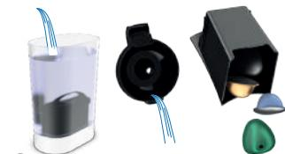
Wassertank mit frischem Trinkwasser auffüllen. Abtropfschale und Kapselbehälter ausleeren.
