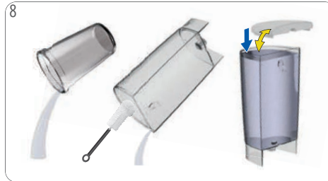
8 เทภาชนะและล้างให้สะอาด ชะล้างและทำความสะอาด ถังน้ำ ใช้แปรงสะอาดที่ใช้กับอาหารได้และน้ำยาล้างจาน ตามความจำเป็นเติมน้ำต้มสะอาดลงในถังและใส่ถังเข้า ในเครื่อง วางภาชนะใต้ช่องทางออกของเครื่องดื่ม
