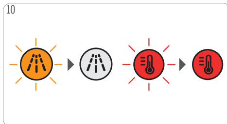
10 ดวงไฟขึ้นบอกการล้างคราบตะกอนดับไป ไฟเลือกอุณหภูมิ กะพริบ และเปลี่ยนเป็นสว่างนิ่งเป็นสีแดงเมื่อเครื่องพร้อม ใช้งาน
