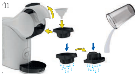
11 เอาภาชนะออกมา เทภาชนะและล้างให้สะอาด ตึงถาดใส่ แคลชูลออกมา นำเครื่องมือล้างออกมาเก็บไว้ในที่ปลอดภัยสำหรับใช้ทำความสะอาดหรือล้างขจัดคราบตะกอน ในภายหลัง ล้างถาดใส่แคลชูลทั้งสองด้านด้วยน้ำต้ม สะอาด สอดถาดใส่แคลชูลเข้าไปใหม่
