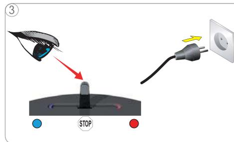
3 Sicherstellen, dass sich der Wahlhebel in der Position "STOP" befindet. Netzstecker in eine Steckdose einstecken.
