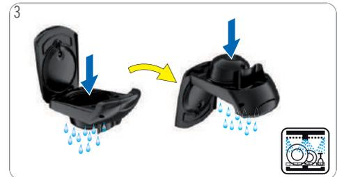
3 Kapselhalter auf beiden Seiten mit Spülmittel und Wasser reinigen. Auch die Reinigung in der Spülmaschine ist möglich. Kapselhalter danach abtrocknen.
