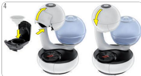
4 Arretierbügel öffnen. Spülsatz in Kapselhalter einsetzen. Kapselhalter in die Maschine einführen. Arretierbügel schließen.
