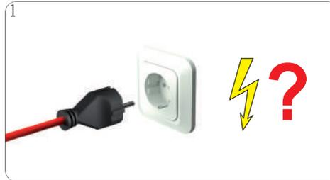
Überprüfen, ob der Netzstecker ordnungsgemäß in eine Steckdose eingesteckt ist. Wenn ja, Stromversorgung überprüfen.
