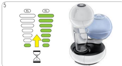
5 Die Leuchten auf der Dosierungsanzeige erscheinen der Reihe nach, während sich die Maschine rund 40 Sekunden lang aufheizt. Danach zeigt die Dosierungsanzeige die letzte Dosiereinstellung. Die Maschine ist bereit. Großen, leeren Behälter unter den Getränkeauslass stellen.
