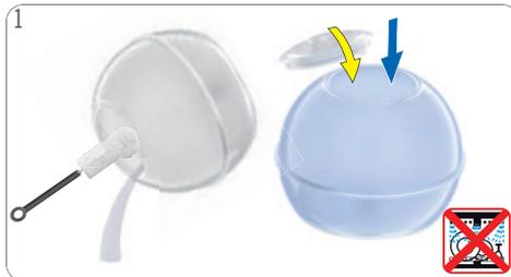
1 Wasserbehälter spülen und reinigen. Bei Bedarf eine Bürste und Spülmittel verwenden. Anschließend mit frischem Trinkwasser füllen und in die Maschine einsetzen. Der Wasserbehälter darf nicht im Geschirrspüler gereinigt werden!
