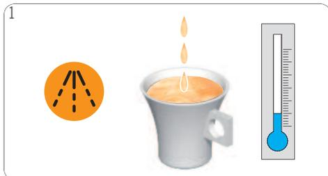
1 Wenn die orange Entkalkungsanzeige aufleuchtet oder das Getränk langsamer als üblich herausläuft (evtl. sogar nur tropfenweise) oder kühler als üblich ist, muss die Maschine entkalkt werden.
