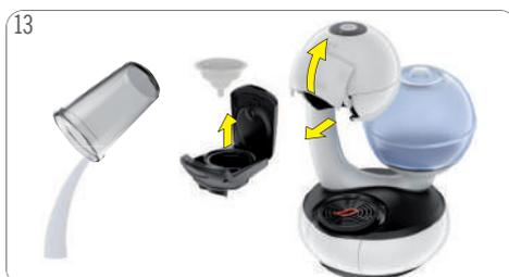
Behälter entfernen. Behälter leeren und reinigen. Kapselhalter herausziehen. Spüleinsatz entfernen. Bewahren Sie sie an einem sicheren Ort auf, damit sie später bei der Reinigung oder Entkalkung zur Verfügung steht. Kapselhalter auf beiden Seiten mit Wasser abspülen. Kapselhalter wieder einsetzen.
