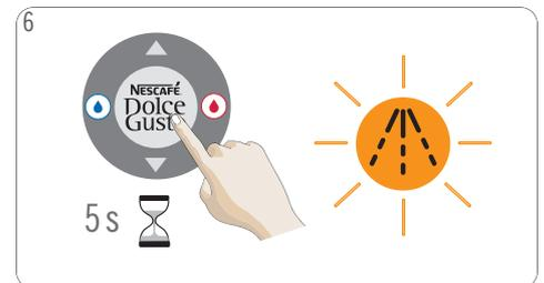
6 EIN/AUS-Taste drücken und mindestens 5 Sekunden gedrückt halten. Die orange Entkalkungsanzeige beginnt zu blinken, und die Maschine wechselt in den Entkalkungsmodus.
