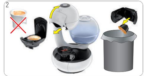
Den Kaffee nicht trinken! Arretierungsbügel öffnen. Die Maschine baut den Druck ab. Kapselhalter entnehmen. Gebrauchte Kapsel in den Abfallbehälter geben.
