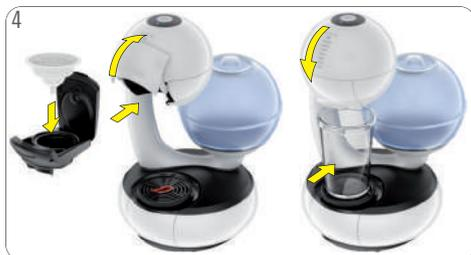
4 Arretierungsbügel öffnen. Spüleinsetz in Kapselhalter einsetzen. Kapselhalter in die Maschine einführen. Arretierungsbügel schließen. Großen, leeren Behälter unter den Getränkeauslass stellen.
