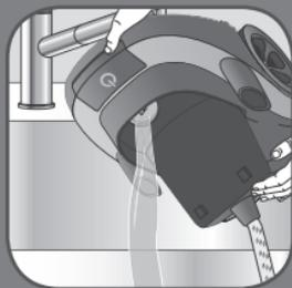
**FR** Inclinez l'appareil verticalement pour vider l'eau dans un évier.
