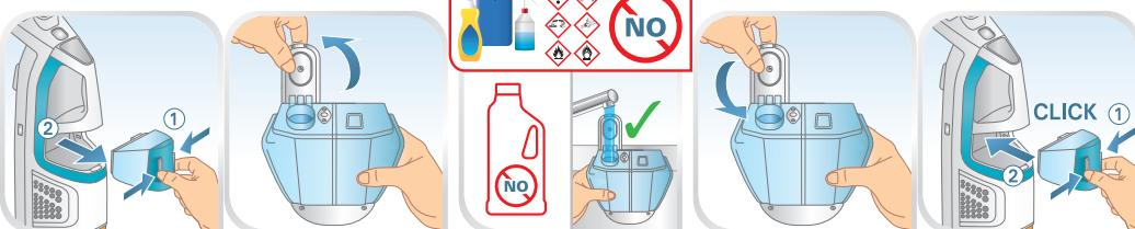
**FR** Remplissez le réservoir d'eau: détachez-le en poussant les loquets. Ouvrez le couvercle et remplissez le d'eau du robinet. Attention: ne pas ajouter de produits chimiques, détergents ou parfums. Fermez le couvercle et replacez le réservoir d'eau dans l'appareil.
