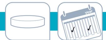
**SL** Filter iz pene, ki se nahaja v posodi za prah, zamenjajte vsakih 6 mesecev. Odstranite pokrov posode za prah in odstranite filter iz pene. Zavrzite ga in namestite novega.
