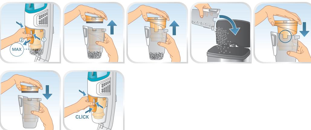
**FR** Pour vider le bac à poussière, appuyer sur les loquets et ôter le du corps de l'appareil. Vdez le bac et remettez en place les différents éléments : le séparateur puis le couvercle avec son filtre. Réinstallez le bac à poussière sur le corps de l'appareil.
