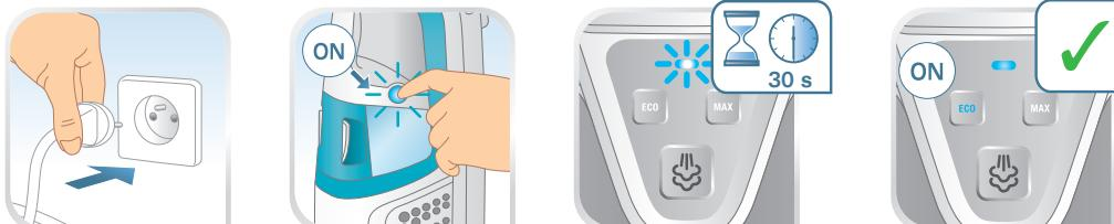
**FR** Pour démarrer l'appareil, branchez-le d'abord, puis appuyez sur le bouton du nettoyeur vapeur portatif. L'appareil est prêt à fonctionner après 30 secondes de chauffe (lorsque le voyant bleu cesse de clignoter).
