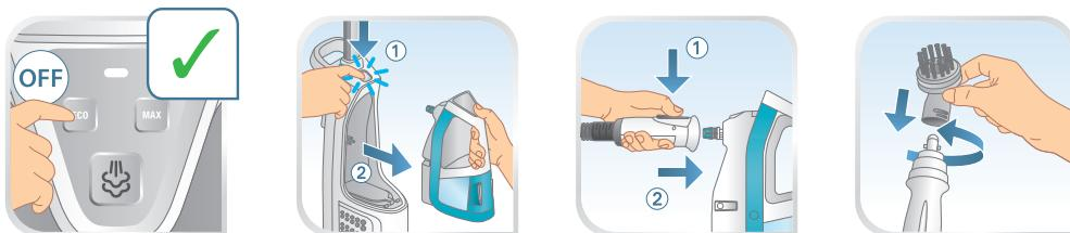
**FR** Attention: désactivez toujours le mode vapeur en appuyant sur le bouton allumé avant de détacher le nettoyeur vapeur portatif. Appuyez sur le bouton de déverrouillage situé sur le dessus de l'appareil principal et tirez sur la poignée du nettoyeur vapeur portatif. Branchez le tube flexible et choisissez l'accessoire que vous souhaitez utiliser.
