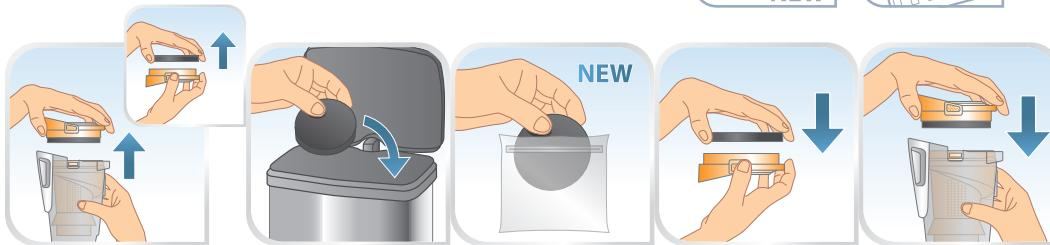
**FR** Remplacez le filtre en mousse du bac à poussière tous les 6 mois. Détachez le couvercle du bac à poussière et retirez le filtre, jetez-le et installez le nouveau filtre.
