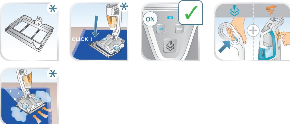
**FR** Pour aspirer et rafraîchir vos tapis avec de la vapeur, utilisez l'accessoire Ultra Glider et choisissez le mode ECO. Il est toujours recommandé de tester une zone isolée de la surface à nettoyer avant de continuer. Laissez d'abord sécher la partie vaporisée afin de vous assurer qu'aucun changement de couleur ou déformation ne se produit.
