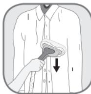
A capa para têxteis delicados assegura uma distribuição igual do vapor, filtra as impurezas da água e protege as roupas das gotas de água.
