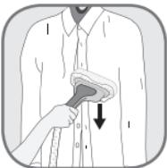
蒸汽罩具有均勻分配蒸汽，過濾水中雜質並防止水滴到布料等功能。
