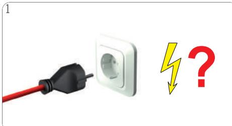
Zkontrolujte, zda je síťová zástrčka správně zapojena do sítové zásuvky. Pokud ano, zkontrolujte přívod elektřiny.
