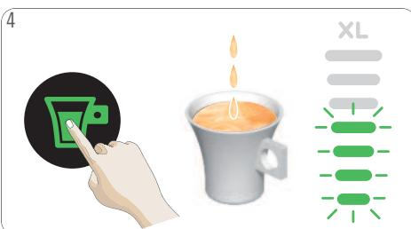
Stiskněte ikonku start/stop. Spustí se příprava nápoje. **Při extrakci neotvírejte zavírací páku.** Výčkejte, dokud se nezastaví extrakce. Přístroj automaticky zastaví přípravu nápoje. Extrakci lze kdykoliv ručně zastavit stisknutím ikonky start/stop.
