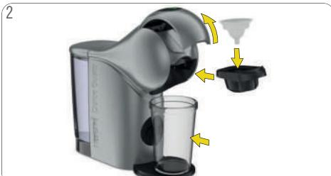
Otevřete zavírací páku. Proplachovací nástroj umístěte do držáku kapslí. Držák kapslí vložte do přístroje. Pod kávovou výpusť umístěte prázdnou velkou nádobu.
