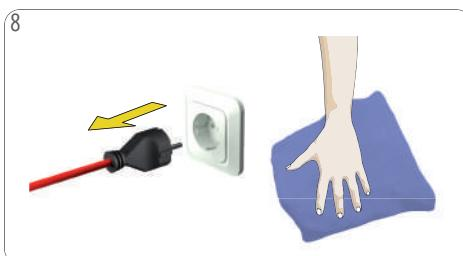
8 Vypněte přístroj. Zástrčku odpojte ze zásuvky! Přístroj vyčistěte měkkou vlhkou utěrkou. Poté jej vyčistěte dosucha měkkou suchou utěrkou.
