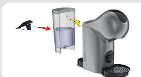
**POKUD PŘÍSTROJ NEBUDE POUŽÍVÁN DĚLE NEŽ 2 DNY:** Vyprázdněte zásobník vody, vypláchněte jej, opět naplňte čerstvou pitnou vodou a vložte jej do přístroje. Než začnete znova vyplachovat přístroj podle pokynů uvedených v části 8. „Čištění“ na straně 17, začněte s kroky 4 až 8.
