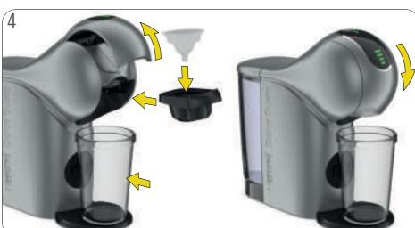
4 Otevřete zavírací páku. Proplachovací nástroj umístěte do držáku kapslí. Držák kapslí vložte do přístroje. Zavřete zavírací páku. Vjměte odkapávací tácek. Pod kávovou výpusť umístěte prázdnou velkou nádobu.
