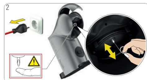
Vyjměte držák kapslí. Otevřete zavírací páku. Vstříkovací trysku vycistěte čisticí jehlou. Řídte se pokyny uvedenými v 9. „Odváření provádějte každé 3–4 měsíce“ na straně 18.
