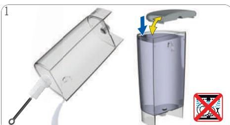
1 Vypláchněte a vyčistěte zásobník vody. V případě potřeby použijte čistý, biologicky bezpečný kartáč a mycí prostředek. Poté zásobník napříte čerstvou pitnou vodou a vložte jej do přístroje. Zásobník vody není určen do myčky nádobí!
