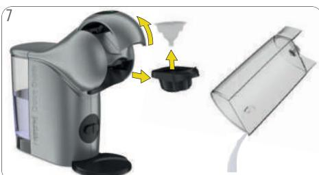
7 Otevřete zavírací páku. Vytáhněte držák kapslí. Vjměte proplachovací nástroj. Uchovejte jej na bezpečném místě pro pozdější čištění nebo odvápnování. Pokud v zásobníku vody zůstala voda, vyprázdněte ji.
