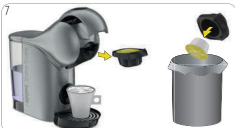
Otevřete zavírací páku. Vytáhněte držák kapslí. Vyjměte použitou kapsli. Použité kapsle vyhodte do koše.
