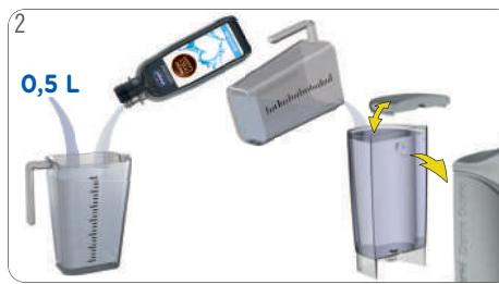
Pokud v zásobníku vody zůstala voda, vyprázdněte ji. V odměrce smíchejte 0,5 l čerstvé pitné vody s obsahem odvápnovače. Odvápnovací roztok nalijte do zásobníku vody a zásobník vložte do přístroje.
