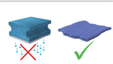
**Nikdy nepoužívejte mokrou houbičku. K čištění povrchu přístroje používejte vždy pouze měkkou vlhkou utěrku.**
