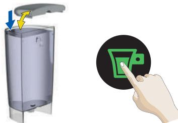
Zkontrolujte, zda je v zásobníku vody dostatek čerstvé pitné vody. Pokud není, napiřte jej čerstvou pitnou vodou a pokračujte v přípravě stisknutím ikonky start/stop. V případě, že nevytéká žádná kapalina, přečtěte si kapitolu 10.3 „NEVYTĚKÁ ŽÁDNÁ TEKUTINA – NENÍ ZASEKNUTA KAPSLE?“.
