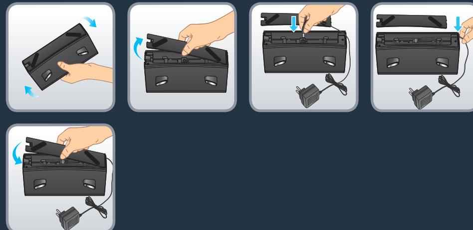
Odstranite spodnji pokrov polnilne postaje in priključite adapter. Bodite pozorni na razporeditev povezovalnih kablov adapterja, da se med pometanjem ne navijejo. Spodnji pokrov namestite nazaj.
