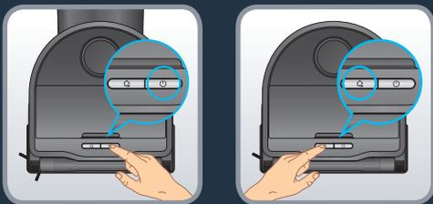
Pritisnite tipku «Start» za pokretanje automatskog čišćenja. Robot će skenirati područje. Automatski će podijeliti prostoriju na male zone, prvo čisti unutar zone cik cak, a zatim čisti rubove zone. Robot će očistiti svu pristupačnu oblast, zonu po zonu. Pritisnite tipku «Start» u bilo kom trenutku da pauzirate čišćenje i pritisnite ga ponovo da nastavite sa čišćenjem. Ako je robot u stanju pripravnosti, jednom pritisnite tipku «Start» da probudite robota i drugi put da počnete sa čišćenjem.
