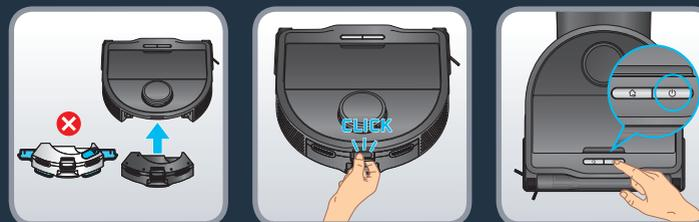
Jestliže chcete robota používat bez funkce mopování (režim „pouze vysavač“), nainstalujte na zadní stranu robota modul „pouze vysavač“. Aby byl modul správně nainstalovaný, musí se ozvat „cvaknutí“. Úklid zahájíte stisknutím tlačítka „Start“ nebo pomocí aplikace. Jestliže nepoužíváte funkci mopování, nechte v robotovi nainstalovaný režim „pouze vysavač“. Modul „pouze vysavač“ je vybaven nabíjecími kontakty, které robotovi umožňují zadokovat do stanice a nabít si baterii.
