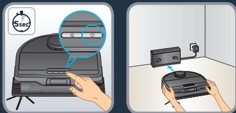
Uključite robot tako da tipku START držite pritisnutom dok se ne uključe indikatori na robotu (~5 sekundi). Robot ručno stavite uz stanicu. Sačekajte 3-4 sata da se robot napuni do kraja. Prije prvog čišćenja provjerite da li se robot napunio do kraja. Kod prvog čišćenja u novom okruženju, robot će kreirati kućnu kartu. Da biste poboljšali tačnost karte, nemojte koristiti vibrirajući spremnik za vodu, neka na robota bude instaliran modul "samo usisavanje".
