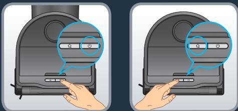
Stisknutím tlačítka „Start“ spustíte automatický úklid. Robot oblast nasnímá. Tím se místnost automaticky rozdělí na malé zóny. Robot nejprve uklidí klikatým pohybem vnitřek zóny a poté okraje zóny. Robot uklidí všechny přístupné oblasti, jednu zónu po druhé. Stisknutím tlačítka „Start“ můžete úklid kdykoliv zastavit a dalším stisknutím v něm zase pokračovat. Pokud je robot v pohotovostním režimu, jedním stisknutím tlačítka „Start“ jej probudíte a druhým stisknutím spustíte úklid.
