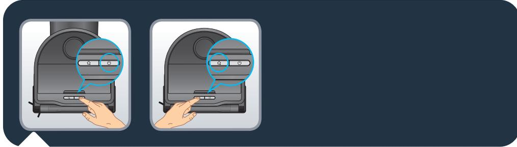
Pritisnite dugme „Pokreni“ za početak automatskog čišćenja. Robot će skenirati područje. Automatski će prostoriju podeliti u zone, prvo će očistiti unutar zone cik-cak kretanjem, a zatim i rubove zone. Robot će očistiti sva dostupna područja zonu po zonu. Pritisnite dugme „Pokreni“ bilo kada da pauzirate čišćenje i ponovo ga pritisnite da biste nastavili. Ako je robot u stanju pripravnosti, jednom pritisnite dugme „Pokreni“ da biste probudili robota i drugi put da pokrenete čišćenje.
