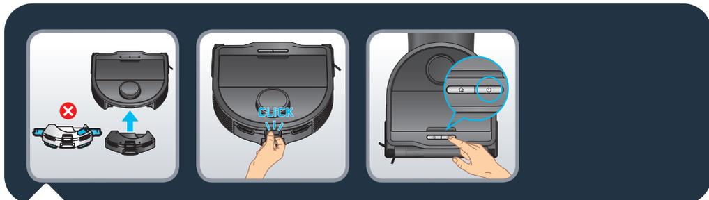
Da biste koristili robot bez funkcije pranja (način „Samo usisavanje“), postavite modul „Samo usisavanje“ na stražnju stranu robota. Modul je pravilno umetnut kada začujete klik. Pritisnite tipku « Pokreni » ili upotrijebite aplikaciju za pokretanje čišćenja. Modul « Samo usisavanje » ostavite u robotu kada ne upotrebljavate funkciju pranja. Modul „Samo usisavanje“ ima kontakte za punjenje koji omogućuju robotu da se priključi na stanicu i napuni bateriju.
