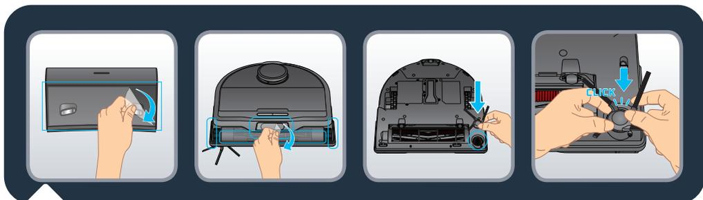
Uklonite sve zaštite (zaštitne slojeve) na stanici i na robotu. Okrenite robot, umetnite bočnu četku tako da lagano sjedne na mjesto. Bočna je četka pravilno umetnuta kada začujete klik.
