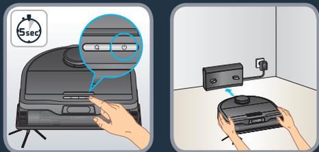
Kapcsolja be a robotot az INDÍTÁS gomb nyomva tartásával, amíg a robot fényei be nem kapcsolnak (kb. 5 másodperc). Helyezze a robotot az állomásra. Várjon 3-4 órát, amíg a robot teljesen feltöltődik. Az első tisztítás alkalmával ellenőrizze, hogy a robot teljesen fel van-e töltve. Az új környezetben végzett első tisztításhoz a robot létrehozza az otthoni térképet. A térkép pontosságának javítása érdekében ne használja a rezgő víztartályt, tartsa a „csak porszívó” modult beszerelve a robotba.
