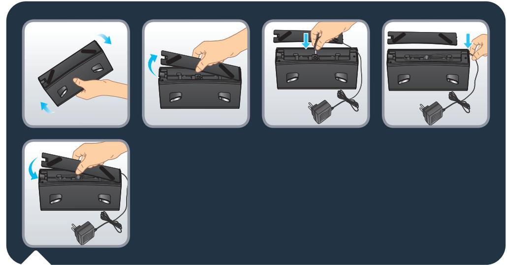
Витягніть нижню кришку док-станції та під'єднайте адаптер. Зверніть увагу на розташування дроту адаптерного з'єднання, щоб уникнути ризику травм у процесі підмітання. Установіть нижню кришку на місце.
