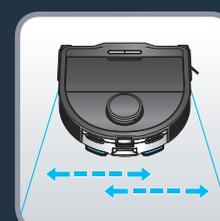
A „csak porszívó” modul kiszéréséhez válassza le a „csak porszívó” modult a retesz megnyomásával és kihúzásával. Vegye ki a víztartályt, és rögzítse a robot hátulján. A víztartály akkor van megfelelően behelyezve, ha kattantást hall. A tisztítás megkezdéséhez nyomja meg az « Indítás » gombot, vagy használja az alkalmazást. A rezgő felmosótartó automatikusan aktiválódik a balról jobbra történő mozgatással.
