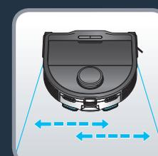
Modul „pouze vysavač“ odepnete tak, že stisknete západku a modul „pouze vysavač“ vytáhnete. Vezměte nádržku na vodu a připeňte ji na zadní stranu robota. Aby byla nádržka na vodu správně nainstalovaná, musí se ozvat „cvaknutí“. Úklid zahájíte stisknutím tlačítka „Start“ nebo pomocí aplikace. Vibrační držák na mop se aktivuje automaticky pohybem zleva doprava.
