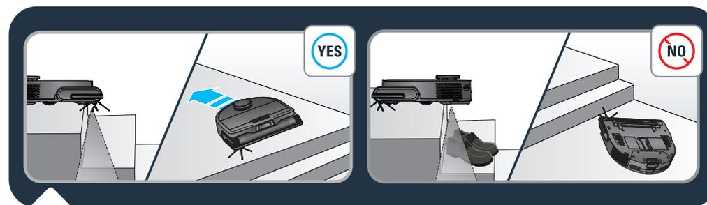
Robot má snímače na ochranu pred pádom na detekciu schodov. Pri ich zistení robot zmení smer. Pre optimálnu účinnosť snímačov na ochranu pred pádom odstráňte všetky predmety (napr. obuv) zo schodov. Keď robot používate vo vyvýšenej časti, postavte fyzickú prekážku na okraj časti, aby ste zabránili nechcenému pádu.
