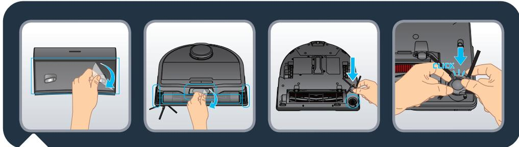
Odstráňte všetky prvky na ochranu pri doprave (ochranné fólie), ktoré sú na stanici a robote. Otočte robot a upevnite bočnú kefu jemným zacvaknutím. Bočná kefa je správne upevnená, keď počujete zvuk cvaknutia.
