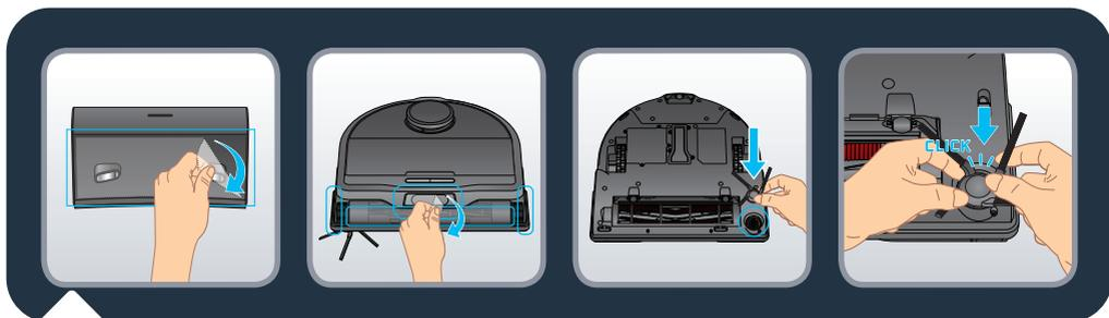
Uklonite svu zaštitu (zaštitne filmove) sa stanice i robota. Okrenite robota, postavite bočnu četku tako što ćete je nežno ubaciti. Bočna četka je ispravno postavljena kada čujete zvuk škljocanja.
