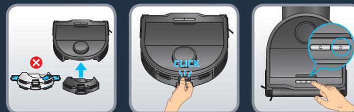
Za korištenje robota bez funkcije brisanja (način rada "samo usisavanje") instalirajte modul "samo usisavanje" na stražnju stranu robota. Modul je ispravno postavljen kada čujete klik. Pritisnite tipku "Start" ili koristite aplikaciju za početak čišćenja. Ostavite modul "samo usisavanje" na robotu kada ne koristite funkciju brisanja. Modul "samo usisavanje" je opremljen kontaktima za punjenje koji omogućavaju robotu da dođe na stanicu i da napuni bateriju.
