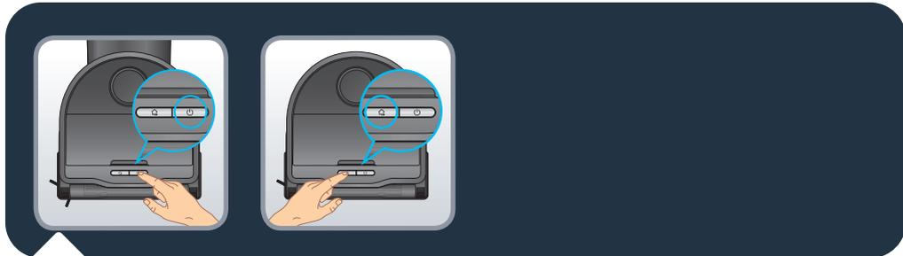
Stlačte tlačidlo « Spustiť », čím začnete automatické čistenie. Robot zoskenuje priestor. Automaticky miestnosť rozdelí na malé zóny, pričom najprv nepravidelným pohybom čistí v rámci zóny a následne po jej okrajoch. Robot vyčistí celý dostupný priestor zónu po zóne. Kedykoľvek stlačte tlačidlo « Spustiť », čím čistenie pozastavíte a opätovným stlačením v čistení pokračujete. Ak je robot v pohotovostnom režime, stlačte tlačidlo « Spustiť » raz, čím ho prebudíte, a druhýkrát, aby začal čistenie.
