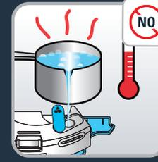
Otvorte vrchnák zásobníka vody a naplňte ho doplna čistou vodou. Nepoužívajte horúcu vodu. Varovanie: Do zásobníka vody nepridávajte čistiace prostriedky. Môžu sa upchať potrubia a zásobník na vodu prestane fungovať.
