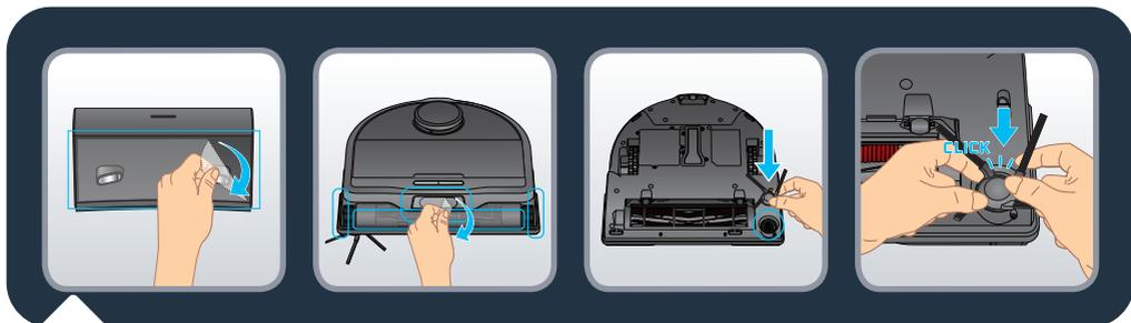
Távolítson el minden védőelemet (védőfóliát) a dokkolóállomásról és a robotról. Fordítsa meg a robotot, szerelje fel az oldalsó kefét úgy, hogy óvatosan hozzácsípteti. Az oldalsó kefe akkor van megfelelően felhelyezve, ha kattantást hall.
