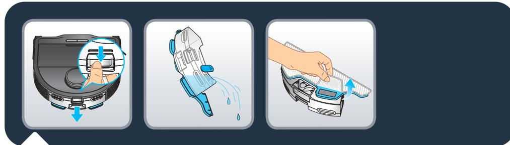
Na koncu čiščenja odprite rezervoar za vodo s pritiskom na zapah in povlecite, da odstranite rezervoar za vodo. Iz rezervoarja za vodo izpraznite preostalo vodo. Odstranite umazano krpo za brisanje.
