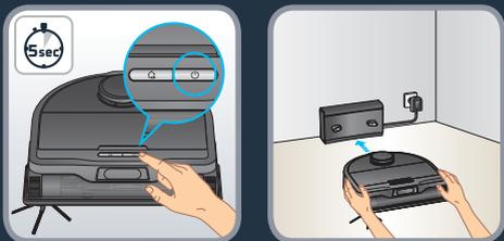
Zapněte robota stisknutím a přidržením tlačítka START, dokud se kontrolky robota nerozsvítí (asi 5 sekund). Ručně umístěte robota ke stanici. Počkejte 3–4 hodiny, než se robot zcela nabije. Při prvním úklidu se přesvědčte, že je robot zcela nabitý. Při prvním úklidu v novém prostředí vytvoří robot mapu domácnosti. Aby byla přesnost mapy lepší, nepoužívejte vibrační vodní nádržku a ponechte v robotovi nainstalovaný modul „pouze vysavač“.
