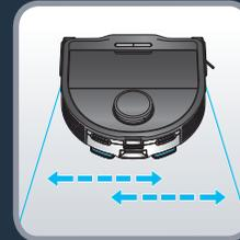
Odvojite modul „samo usisavanje“ tako što ćete pritisnuti rezu i povući da izvadite modul „samo usisavanje“. Uzmite rezervoar za vodu i prikačite ga na zadnji deo robota. Rezervoar za vodu je ispravno postavljen kada čujete zvuk „škljocanja“. Pritisnite dugme „Pokreni“ ili koristite aplikaciju da započnete čišćenje. Nosač vibrirajućeg brisača će se automatski aktivirati kretanjem levo-desno.
