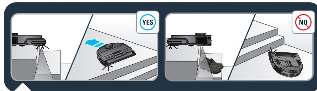
Robot ima senzore za sprečavanje pada za otkrivanje stepenica. Robot će promeniti smer kada ih otkrije. Radi optimalne efikasnosti senzora za sprečavanje pada, uklonite sve predmete (npr. cipele) sa stepenica. Kada robota koristite na podignutoj površini, postavite fizičku prepreku na rubu da biste sprečili slučajne padove.
