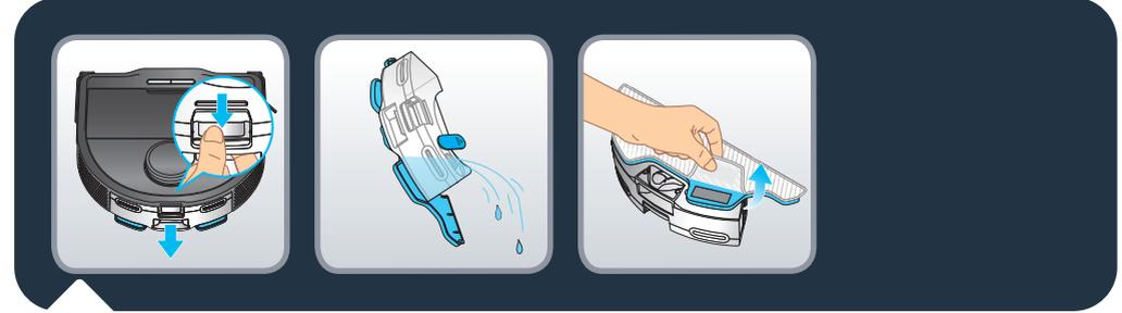
Kada se završi čišćenje, odvojite rezervoar za vodu tako što ćete pritisnuti rezu i povući da izvadite rezervoar za vodu. Ispraznite rezervoar za vodu od preostale vode. Izvadite prljavu krpu za brisanje.
