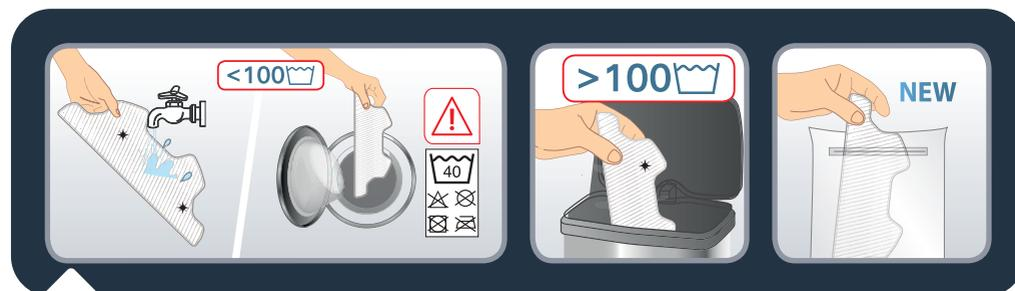
Operite krpu za brisanje pod vodom ili u mašini za veš. Ostavite da se suši 24 sata. Zamijenite krpu za brisanje nakon 100 pranja. Možete kupiti komplet novih krpa [www.rowenta.com](http://www.rowenta.com)
