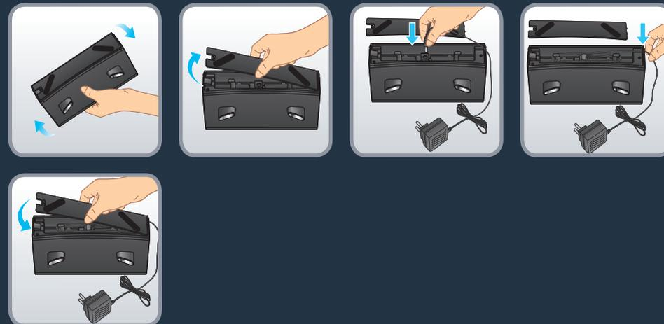
Skinite donji poklopac priključne stanice i povežite adapter. Takođe vodite računa o raspoređivanju kablova za povezivanje adaptera da bi se izbeglo njihovo upetljavanje tokom čišćenja. Vratite donji poklopac.
