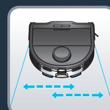
Odprite modul "samo sesanje", tako da pritisnete zapestek in povlečete, da odstranite modul "samo sesanje". Vzemite rezervoar za vodo in ga pritrdite na zadnji del sesalnika. Ko zaslišite klik, je rezervoar za vodo pravilno nameščen. Za začetek čiščenja pritisnite gumb za zagon ali uporabite aplikacijo. Vibrirajoči nosilec krpe se samodejno aktivira z gibom od leve proti desni.
