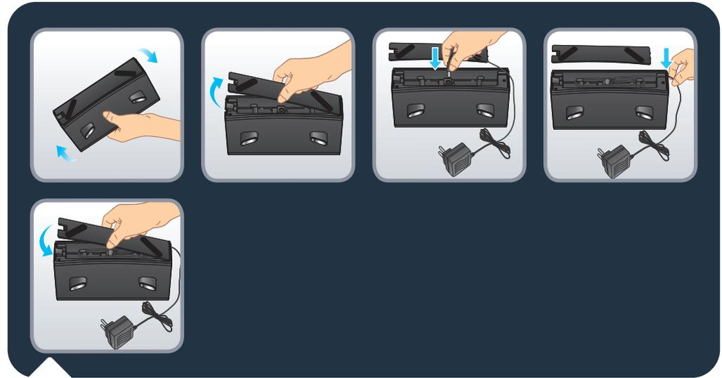
Zložte spodný kryt a pripojte dokovaciu stanicu k adaptéru. Dbajte na usporiadanie pripájacích káblov adaptéra, aby ste sa pri upratovaní neporanili. Založte spodný kryt späť.
