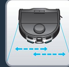
Від'єднайте модуль «лише пилосос», натиснувши на фіксатор, і потягніть, щоб зняти його. Візьміть резервуар для води та закріпіть його ззаду робота. Якщо ви почули звук клацання, резервуар для води встановлено правильно. Щоб розпочати прибирання, натисніть кнопку пуску або скористайтеся програмою. Вібраційна насадка для швабри автоматично активується рухом зліва направо.
