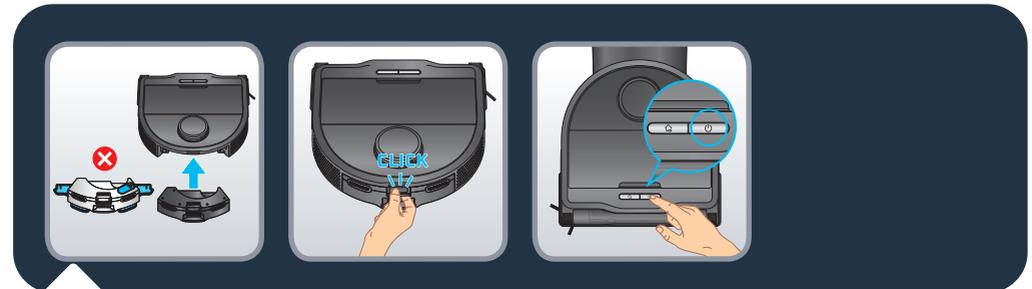
Для використання робота без функції прибирання (режим «лише пилосос»), установіть модуль «лише пилосос» ззаду робота. Якщо ви почули звук клацання, модуль встановлено правильно. Щоб розпочати прибирання, натисніть кнопку пуску або скористайтеся програмою. Якщо ви не використовуєте функцію миття, тримайте встановленим у робота модуль «лише пилосос». Модуль «лише пилосос» має зарядні пластини, щоб робот міг під'єднатися до станції та зарядити акумулятор.
