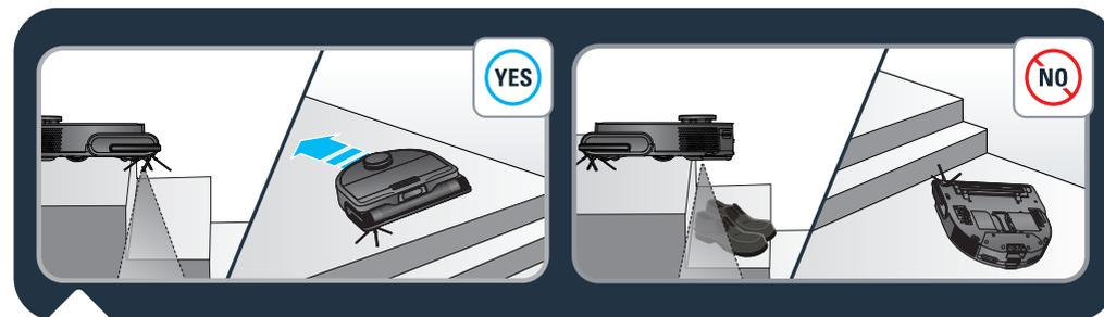
Robot má snímače proti pádu, pomocí kterých dokáže rozpoznat schody. Když je zjistí, změní robot směr. Aby snímače proti pádu fungovaly optimálně, odstraňte ze schodišť všechny předměty (např. boty). Při používání robota ve vyvýšené oblasti umístěte na okraj fyzickou překážku, abyste zabránili náhodným pádům.
