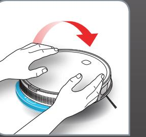
**RU** Закрепите насадку для влажной уборки на пылесосе с помощью двух специальных отверстий.
