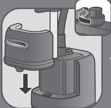
**ES** Enrosque completamente la tapa del depósito de agua y vuelva a introducir el depósito en el aparato.
