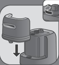
**NL** Draai de dop vast en breng het reservoir opnieuw aan in het apparaat.
