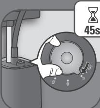
**ES** Gire el Botón Encender/Apagar, para encender el aparato. Después ajuste la salida de vapor girando el botón.
