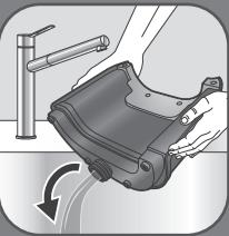
**ES** Desenrosque la tapa y, a continuación, vacíe completamente el depósito de agua en el fregadero.
