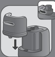
**FR** Vissez complètement le bouchon du réservoir d'eau et replacez le réservoir dans l'appareil.
