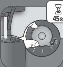
**NL** Draai de ON/OFF knop om het apparaat in te schakelen en stel het gewenste stoomdebit in.
