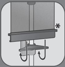
**FR** Desserrez le support et attachez-le, en réglant la tension avec l'accroche prévu à cet effet. Puis verrouillez.
