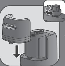
**FR** Revissez le bouchon du réservoir et replacez le réservoir dans l'appareil.
