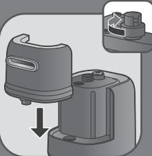
**ES** Vuelva a enroscar la tapa y coloque de nuevo el depósito de agua en el aparato.
