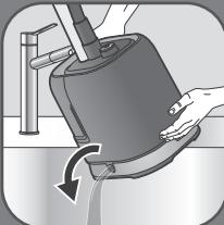
**NL** Kantel het apparaat verticaal om het mengsel in de gootsteen af te voeren.
