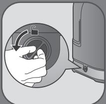
**NL** Breng het apparaat boven een gootsteen en schroef de "antikalk" dop tegen de klok in los.
