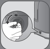
**FR** Placez l'appareil au-dessus d'un lavabo et dévissez le capuchon « anti calcaire » en le tournant dans le sens antihoraire.
