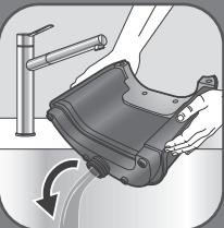
**NL** Schroef de dop los en leeg het waterreservoir boven een gootsteen.
