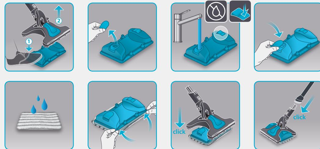
**FR** **Rémpissage :** Détachez le réservoir d'eau de la tête de nettoyage. Retirez le bouchon et remplissez le réservoir d'eau\* en position inclinée avec la pédale en position « **goutte barrée** ». Refermez le bouchon une fois le remplissage terminé. Humidifiez légèrement la lingette avant de la placer sur le réservoir d'eau et replacez le réservoir d'eau sur l'appareil.
