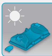
**FR** Remplir environ 1/3 du réservoir d'eau en vinaigre blanc ménager et le laisser s'écouler en statique dans l'évier jusqu'à ce qu'il se vide. Rincer le réservoir à l'eau. Laisser sécher A renouveler chaque mois.
