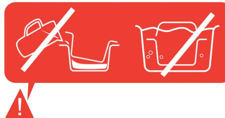
En cas d'immersion accidentelle de l'appareil ou si de l'eau a été versée directement sur l'élément chauffant en l'absence de la cuve, emmenez l'appareil dans un Centre de Service Agréé.
