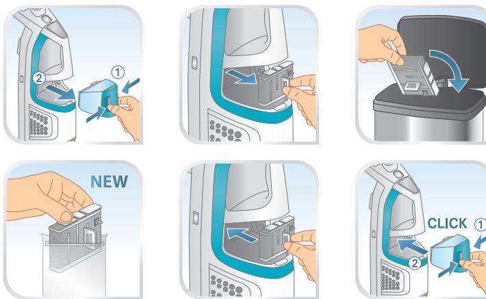
**PL** Filtr przeciwdziałający powstawaniu kamienia kotłowego (znajdujący się za zbiornikiem wody) należy wymieniać raz na 3 miesiące. Przestrzeganie 3-miesięcznego okresu wymiany filtra jest ważne, aby urządzenie dłużej i bezproblemowo służyło.
