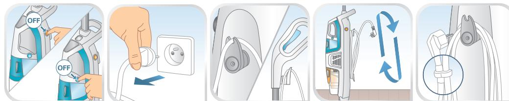
**PL** Po każdym użyciu urządzenie należy wyłączyć (nacisnąć przyciski pary i odkurzania). Należy wyjąć wtyczkę z kontaktu i zwinąć sznur urządzenia.
