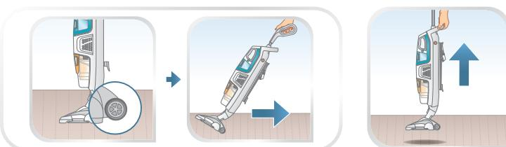
**PL** Do transportowania urządzenia należy używać albo kółek transportowych, albo uchwytu transportowego (znajdującego się z tyłu urządzenia).
