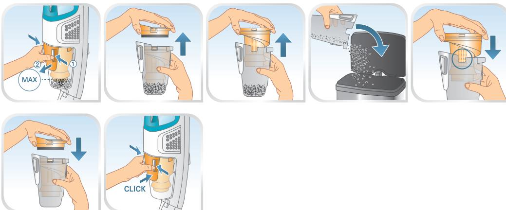
**PL** Aby opróżnić pojemnik na kurz, należy wcisnąć 2 zatrzaski i wyciągnąć go z urządzenia. Należy opróżnić pojemnik i założyć elementy z powrotem: najpierw separator, potem filtr i jego pokrywę. Założyć pojemnik na kurz z powrotem.
