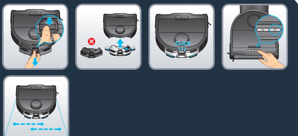
Liberte o módulo “aspiração” premindo o trinco e puxando para retirar o módulo “aspiração”. Encaixe o módulo “aspiração e limpeza” na parte de trás do robot. O módulo “aspiração e limpeza” estará corretamente instalado quando ouvir um “clique”. Prima o botão “Iniciar” ou utilize a app para iniciar a limpeza. O suporte de mopa oscilante será automaticamente ativado com um movimento da esquerda para a direita.
