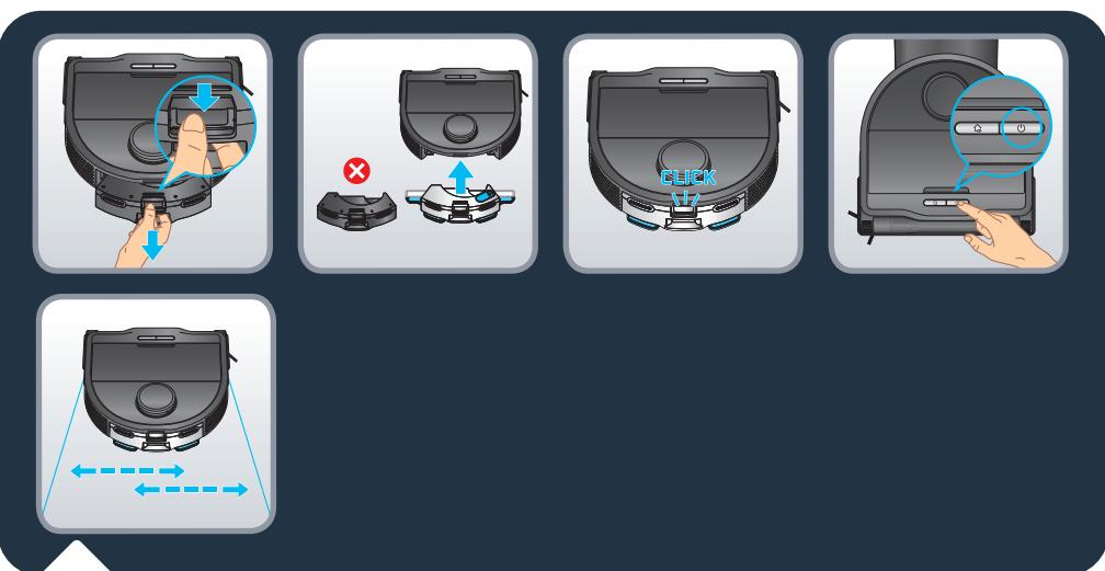
Sganciare il modulo "Solo aspirazione" premendo il dispositivo di chiusura e tirare per rimuovere il modulo. Prendere il serbatoio dell'acqua e fissarlo sul retro del robot. Il serbatoio dell'acqua è installato correttamente quando si sente uno scatto. Premere il pulsante "Start" o utilizzare l'app per avviare la pulizia. La staffa del mop vibrante viene attivata automaticamente con un movimento da sinistra a destra.
