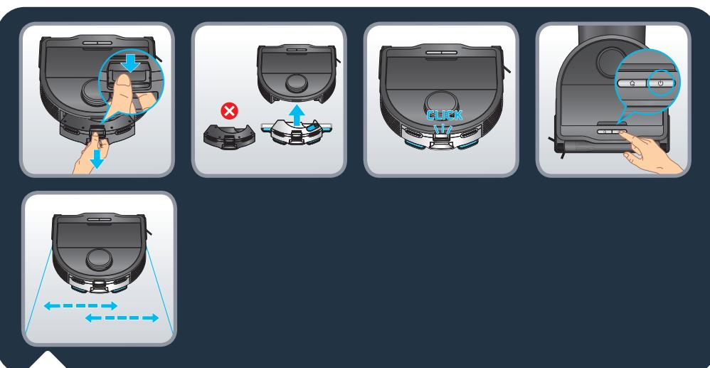
Lösen Sie das Modul „Nur Saugen“, indem Sie auf die Verriegelung drücken und es herausziehen. Bringen Sie den Wassertank an der Rückseite des Roboters an, sodass er einrastet. Der Wassertank ist korrekt eingesetzt, wenn Sie ein Klickgeräusch hören. Drücken Sie die Taste „Start“ oder starten Sie den Reinigungsvorgang über die App. Die Halterung des vibrierenden Mopps wird automatisch durch eine Bewegung von links nach rechts aktiviert.
