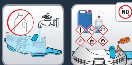
Aprire il fermo del serbatoio dell'acqua e versare acqua pulita finché il serbatoio non è pieno. Non utilizzare acqua calda. Avvertenza: Non aggiungere detergenti nel serbatoio dell'acqua. Ciò potrebbe ostruire il tubo e influire sul funzionamento del serbatoio dell'acqua.
