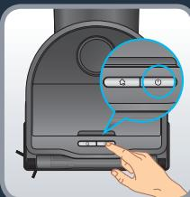
Pentru a folosi robotul fără funcția de șters pe jos (modul „doar aspirat”), instalați-i în partea din spate modulul „doar aspirat”. Modulul este montat corect când auziți un clic. Apăsați butonul „Start” sau folosiți aplicația pentru a începe curățenia. Păstrați modul „doar aspirat” instalat în robot când nu folosiți funcția de șters pe jos. Modulul „doar aspirat” este echipat cu contacte de încărcare, care îi permit robotului să se conecteze la stație și să-și încarce bateria.
