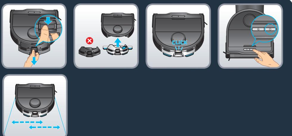
Déclipsez le module « aspirateur uniquement » en appuyant sur le loquet et en tirant pour retirer le module. Prenez le réservoir d'eau et fixez-le à l'arrière du robot. Le réservoir d'eau est correctement installé lorsque vous entendez un « clic ». Appuyez sur le bouton « Démarrer » ou utilisez l'application pour démarrer le nettoyage. Le support de serpillière à vibration s'activera automatiquement avec un mouvement de gauche à droite.
