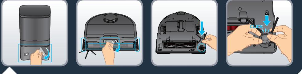
Retire todas as proteções (películas protetoras) da base e do robot. Vire o robot e instale a escova lateral, encaixando-a cuidadosamente. A escova lateral estará corretamente instalada quando ouvir um clique.
