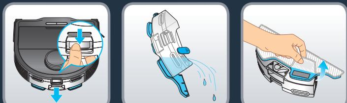
В края на сесията за почистване разкачете резервоара за вода, като натиснете езичето и издържате, за да отстраните контейнера за вода. Излейте останалата вода от контейнера. Отстранете мръсната кърпа на мопа.
