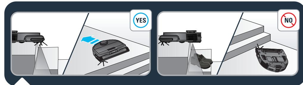
Il robot è dotato di sensori anti-caduta che rilevano la presenza di scale. Il robot cambia direzione quando le rileva. Per un'efficienza ottimale dei sensori anti-caduta, rimuovere qualsiasi oggetto (ad esempio le scarpe) dalle scale. Quando si utilizza il robot in un'area sollevata, posizionare una barriera fisica sul bordo per evitare cadute accidentali.
