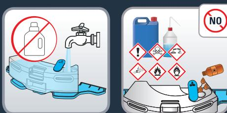
Ouvrez le bouchon du réservoir d'eau et remplissez-le entièrement d'eau propre. N'utilisez pas d'eau chaude. Avertissement : N'ajoutez pas de produits de nettoyage dans le réservoir d'eau. Cela peut obstruer les tuyaux et empêcher le fonctionnement du réservoir d'eau.
