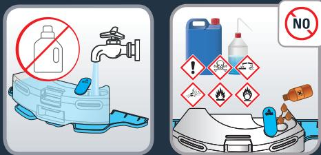
Deschideți opritorul de la rezervorul de apă și umpleți rezervorul cu apă. Nu folosiți apă caldă. Avertisment: Nu adăugați detergenti în rezervorul de apă.
