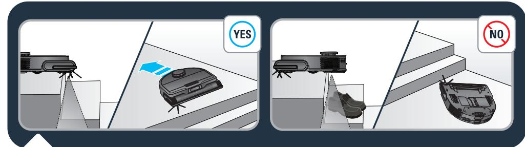
De robot is voorzien van antivalsensoren om trappen te detecteren. De robot verandert van richting zodra deze worden gedetecteerd. Voor optimale efficiëntie van de antivalsensoren verwijdert u alle voorwerpen (bijv. schoenen) van de trap. Wanneer u de robot in een verhoogd gebied gebruikt, plaatst u een fysieke barrière aan de rand van de schuine om te voorkomen dat de robot per ongeluk valt.
