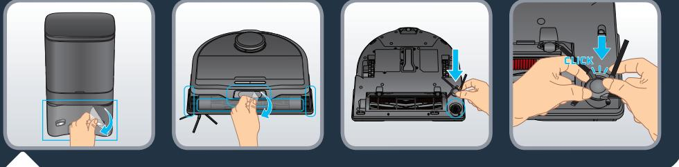
Scoateți toate protecțiile (foliile de protecție) de pe stație și de pe robot. Întoarceți robotul și montați peria laterală prințând-o cu grijă. Peria laterală este montată corect când auziți un clic.
