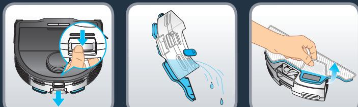
Al final de la sesión de limpieza, desengancha el depósito de agua; para ello, tira del pasador y extrae el depósito de agua. Vacía el agua que pueda quedar en el depósito. Quita la mopa sucia.
