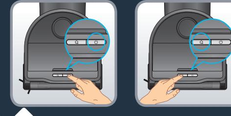
Apăsați butonul „Start” pentru a porni curățenia automată. Robotul va scana suprafața. Va împărți automat încăperea în zone mici, curățând mai întâi în zigzag interiorul zonei, apoi marginile. Robotul va curăța toată suprafața accesibilă, zonă cu zonă. Apăsați butonul „Start” în orice moment pentru a întrerupe curățenia și apăsați-l din nou pentru a o relua. Dacă robotul este în standby, apăsați butonul „Start” o dată pentru a activa robotul și a doua oară pentru a începe curățarea.
