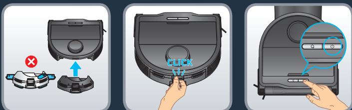
Para utilizar o robot sem a função de limpeza (modo “aspiração”), instale o módulo “aspiração” na parte de trás do robot. O módulo estará corretamente instalado quando ouvir um “clique”. Prima o botão “Iniciar” ou utilize a app para iniciar a limpeza. Mantenha o módulo “aspiração” instalado no robot quando não estiver a utilizar a função de limpeza. O módulo “aspiração” está equipado com placas de carregamento para permitir que o robot fique ancorado na base e carregue a bateria.
