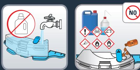
Abre el tapón del depósito de agua y llénalo hasta arriba con agua limpia. No utilices agua caliente. Advertencia: No añadas agentes de limpieza en el depósito de agua. Esto puede atascar las tuberías y provocar que el depósito de agua deje de funcionar.
