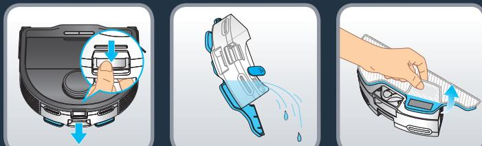
No final da sessão de limpeza, liberte o depósito de água pressionando o trinco e puxe para remover o depósito de água. Esvazie o depósito de água. Retire o pano sujo da mopa.
