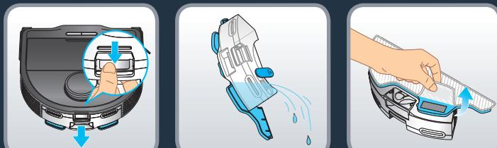
Maak aan het einde van de reinigingssessie het waterreservoir los door op de vergrendeling te drukken en te trekken om het waterreservoir te verwijderen. Leeg het waterreservoir. Verwijder de vuile dweil.
