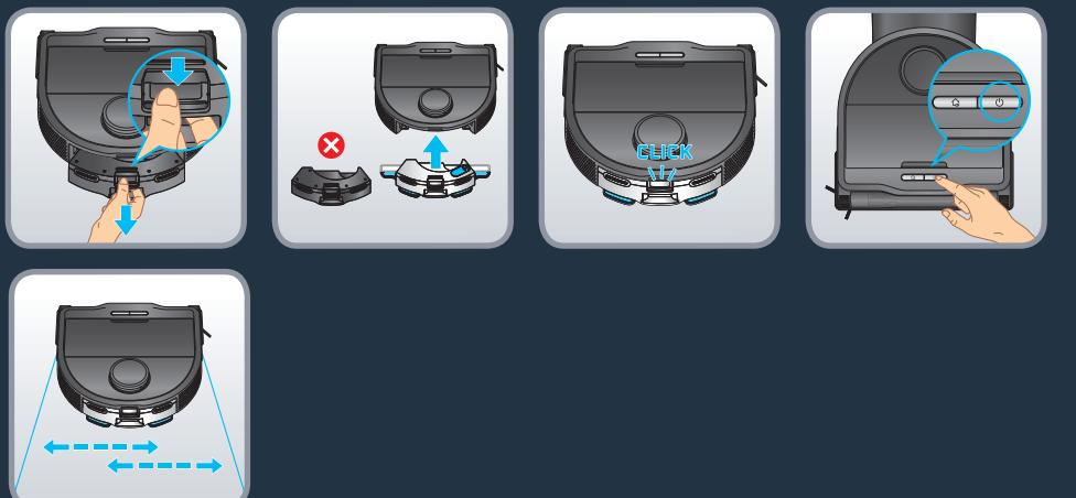
Pulsa el seguro y tira del módulo "Solo aspirador" para extraerlo. Acopla el depósito de agua a la parte posterior del robot. El depósito de agua está instalado correctamente cuando se escucha un clic. Pulsa el botón para iniciar o utiliza la aplicación para comenzar la limpieza. El soporte para mopa vibratorio se activará automáticamente con un movimiento de izquierda a derecha.
