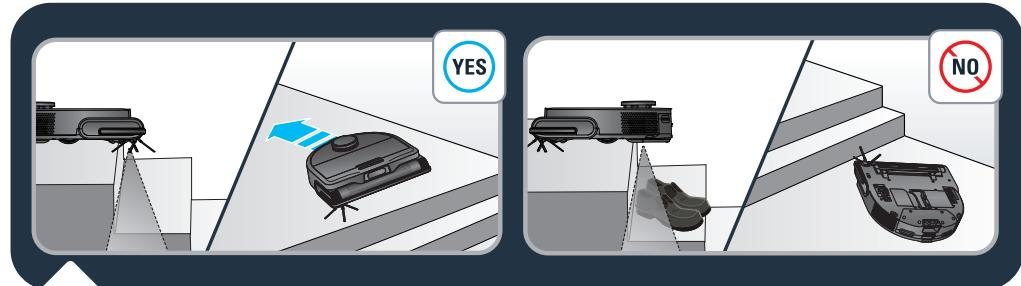
Robotul are senzori anti-cădere pentru a detecta scări. Robotul își va schimba direcția când le va detecta. Pentru o eficiență optimă a senzorilor anti-cădere, luați toate obiectele (de ex. pantofi) de pe scări. Când folosiți robotul într-o zonă înălțată, puneți o barieră fizică pe margine, pentru a preveni căderile accidentale.
