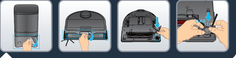
Entfernen Sie alle Schutzfolien an der Station und am Roboter. Drehen Sie den Roboter um und bringen Sie die Seitenbürste vorsichtig an, sodass sie einrastet. Die Seitenbürste ist korrekt angebracht, wenn Sie ein Klickgeräusch hören.
