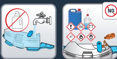
Open de stopper van het waterreservoir en vul met schoon water totdat het waterreservoir vol is. Gebruik geen heet water. Waarschuwing: Voeg geen reinigingsmiddelen toe aan het waterreservoir. Dit kan ervoor zorgen dat de leidingen verstopt raken en dat het waterreservoir niet meer werkt.
