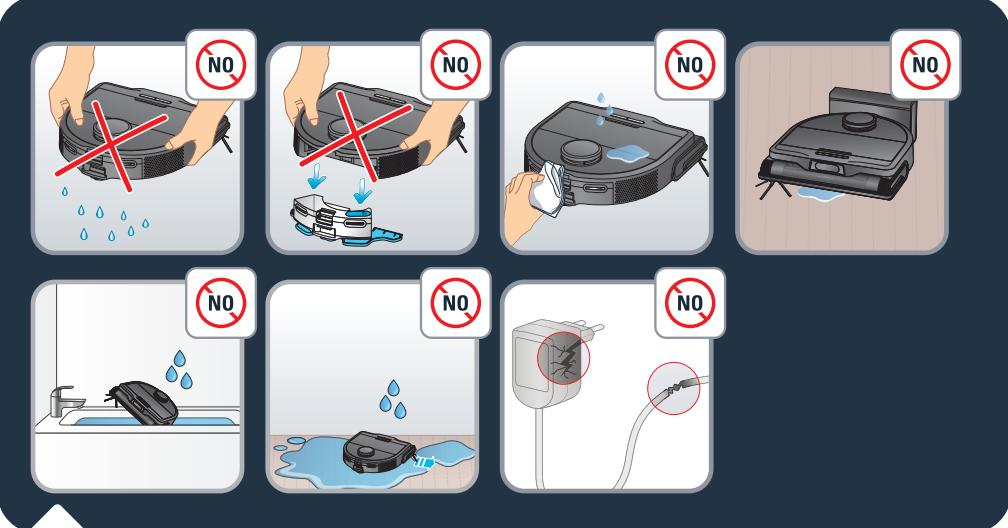
Не клатете робота. Не се опитвайте да разглобявате скобата на вибриращия моп от резервоара за вода. Не поливайте с вода и не поставяйте мокри кърпа върху робота. Не зареждайте робота, когато подът е покрит с вода. Не потапяйте робота във вода. Не използвайте робота върху мокри повърхности или повърхности с локви от вода.
