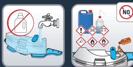
Abra a tampa do módulo “aspiração e limpeza” e encha-o com água limpa até encher. Não utilize água quente. Aviso: não adicione agentes de limpeza ao reservatório de água. Tal pode obstruir os tubos e fazer com que o módulo de aspiração e limpeza deixe de funcionar.
