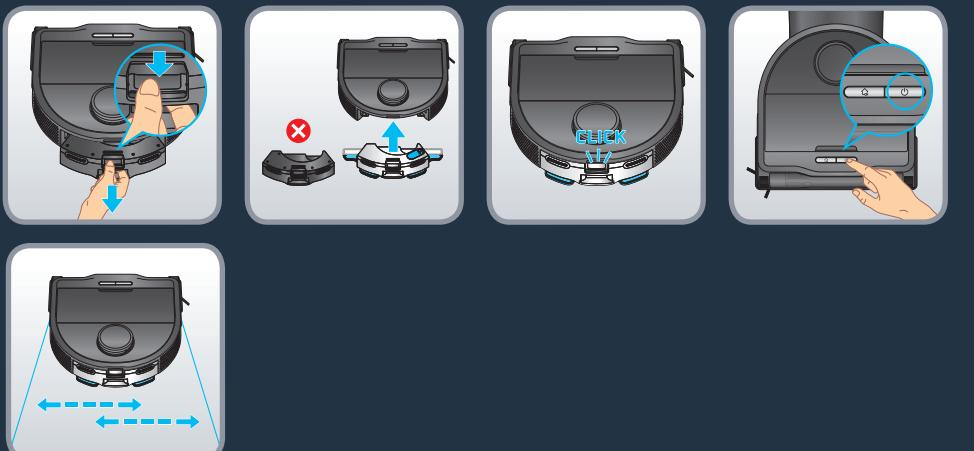
Maak de module 'Alleen stofzuigen' los door op de vergrendeling te drukken en te trekken om de module 'Alleen stofzuigen' te verwijderen. Neem het waterreservoir en klik het vast aan de achterkant van de robot. Het waterreservoir is correct geïnstalleerd wanneer u een klik hoort. Druk op de knop Start of gebruik de app om het reinigen te starten. De vibrerende dweilsteen wordt automatisch geactiveerd bij een beweging van links naar rechts.
