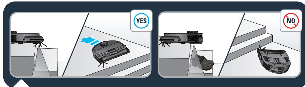
El robot dispone de sensores anticaídas para detectar escaleras. El robot cambiará de dirección cuando las detecte. Para obtener una eficiencia óptima de los sensores anticaídas, retira cualquier elemento (por ejemplo, zapatos) de las escaleras. Cuando utilices el robot en un área elevada, coloca una barrera física en el borde del desnivel para evitar que se caiga accidentalmente.
