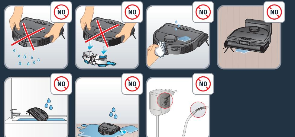
Schütteln Sie den Roboter nicht. Versuchen Sie nicht, die Halterung des vibrierenden Mopps vom Wasserbehälter zu trennen. Vermeiden Sie, dass der Roboter mit Wasser oder einem feuchten Tuch in Kontakt kommt. Laden Sie den Roboter nicht auf, wenn der Boden unter Wasser steht. Tauchen Sie den Roboter nicht unter Wasser. Verwenden Sie den Roboter nicht auf nassen Oberflächen oder auf Oberflächen mit stehendem Wasser.
