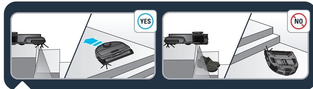
Der Roboter ist mit Absturzsensoren versehen, um Treppen zu erkennen. Der Roboter ändert seine Richtung, wenn er solche erkennt. Entfernen Sie alle Gegenstände (z. B. Schuhe) von Treppen, um eine optimale Funktion der Absturzsensoren zu gewährleisten. Wenn Sie den Roboter in einem erhöhten Bereich verwenden, platzieren Sie eine physische Barriere am Rand des Bereichs, um versehentliches Herabfallen zu verhindern.
