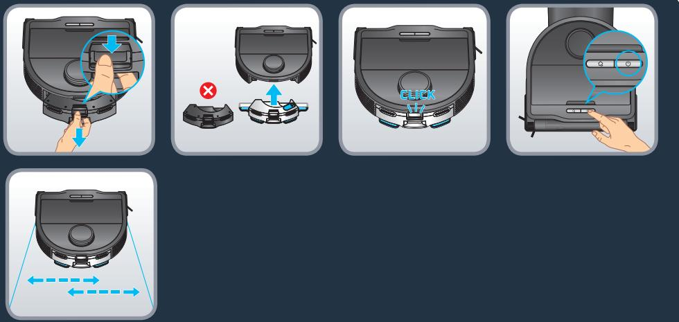
Desprindeți modulul „doar aspirat” apăsând pe prindere și trageți-l pentru a-l scoate. Luați rezervorul de apă și prindeți-l în partea din spate a robotului. Rezervorul de apă este montat corect când auziți un clic. Apăsați butonul „Start” sau folosiți aplicația pentru a începe curățenia. Suportul vibrator de mop va fi activat automat cu o mișcare de la dreapta la stânga.
