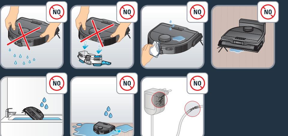
Ne secouez pas le robot. N'essayez pas de détacher le support de serpillière à vibration du réservoir d'eau. Ne placez pas d'eau ou de chiffon humide sur le robot. Ne chargez pas le robot lorsque le sol est inondé. Ne plongez pas le robot dans l'eau. N'utilisez pas le robot sur des surfaces humides ou sur des surfaces avec de l'eau stagnante.
