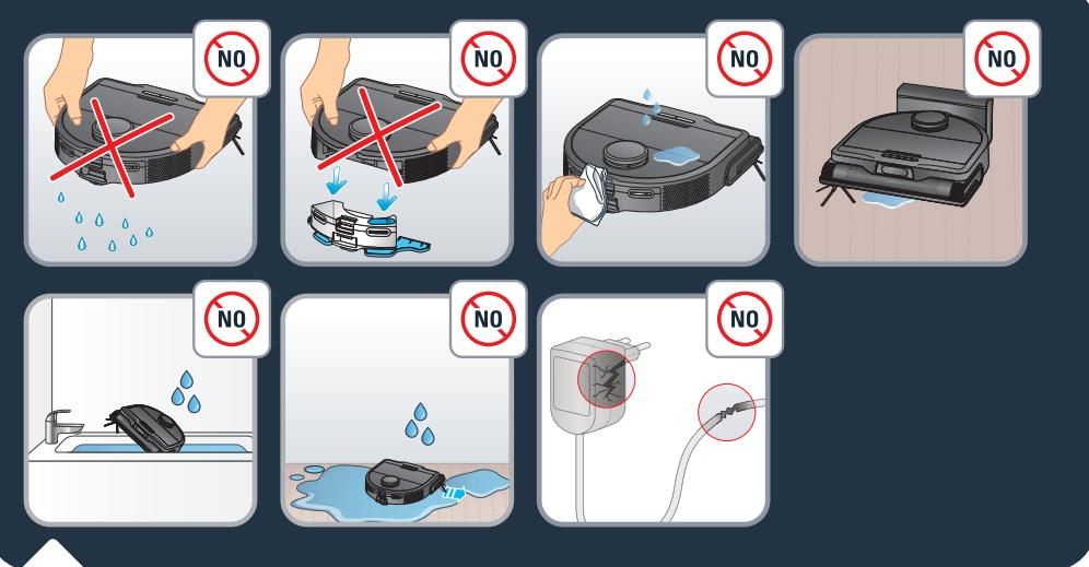
Não abane o robot. Não tente desmontar o suporte de mopa oscilante do módulo "aspiração e limpeza". Não coloque água ou qualquer pano húmido no robot. Não carregue o robot quando o piso estiver inundado. Não mergulhe o robot em água. Não utilize o robot em superfícies molhadas ou com água.
