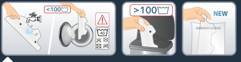
Waschen Sie das Wischtuch unter fließendem Wasser oder in der Waschmaschine. Lassen Sie es 24 Stunden trocknen. Tauschen Sie das Wischtuch nach 100 Reinigungsvorgängen aus. Sie können einen Satz neuer Mopps kaufen auf [www.rowenta.com](http://www.rowenta.com)
