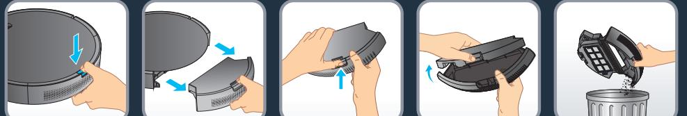
**RU** После каждого использования следует очищать контейнер для мусора. Для этого следует нажать кнопку на задней стороне робота и извлечь контейнер, после откинуть крышку, чтобы очистить его.
