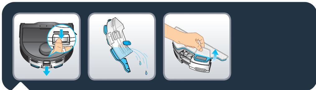
Lösen Sie am Ende der Reinigung den Verschluss des Wassertanks, indem Sie die Lasche drücken, und ziehen Sie am Tank, um ihn zu entfernen. Leeren Sie das restliche Wasser aus dem Wassertank. Entfernen Sie das verschmutzte Wischtuch.
