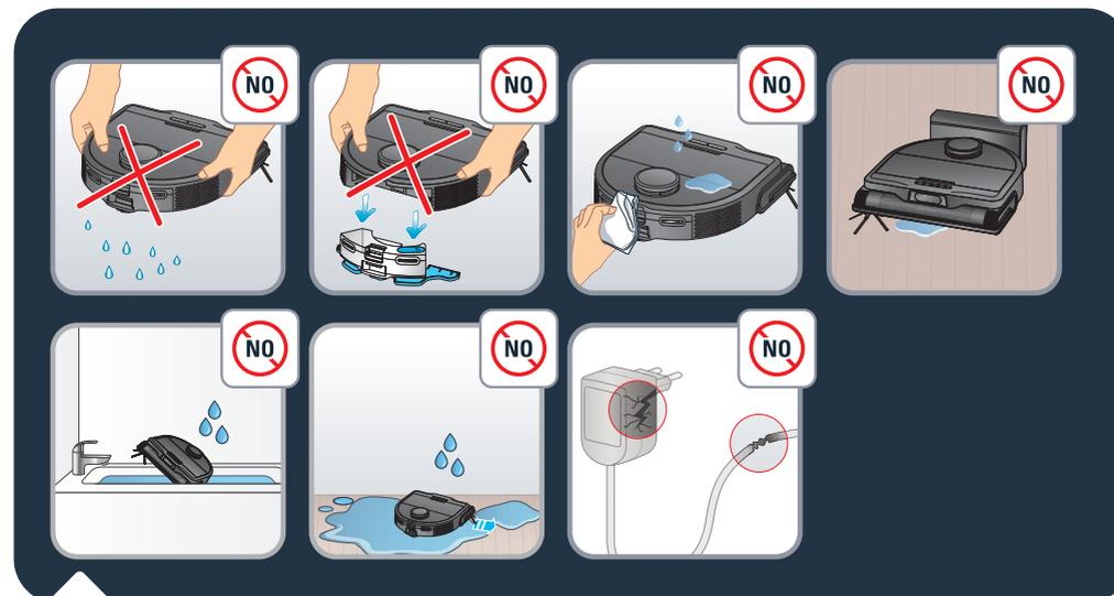
Non scuotere il robot. Non tentare di smontare la staffa per mop vibrante dal serbatoio dell'acqua. Non mettere acqua o panni bagnati sul robot. Non caricare il robot quando il pavimento è allagato. Non immergere il robot nell'acqua. Non utilizzare il robot su superfici bagnate o con acqua stagnante.
