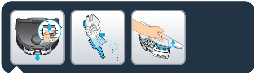
Al final de la sesión de limpieza, desengancha el depósito de agua; para ello, tira del pasador y extrae el depósito de agua. Vacía el agua que pueda quedar en el depósito. Quita la mopa sucia.
