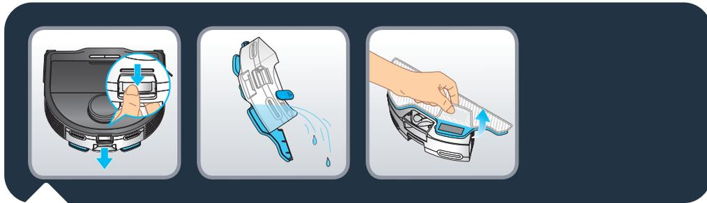
Maak aan het einde van de reinigingssessie het waterreservoir los door op de vergrendeling te drukken en te trekken om het waterreservoir te verwijderen. Leeg het waterreservoir. Verwijder de vuile dweil.
