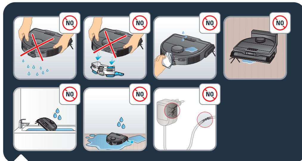
Не клатете робота. Не се опитвайте да разглобявате скобата на вибрацията mop от резервоара за вода. Не поливайте с вода и не поставяйте мокри кърпа върху робота. Не зареждайте робота, когато подът е покрит с вода. Не потапяйте робота във вода. Не използвайте робота върху мокри повърхности или повърхности с локви от вода.
