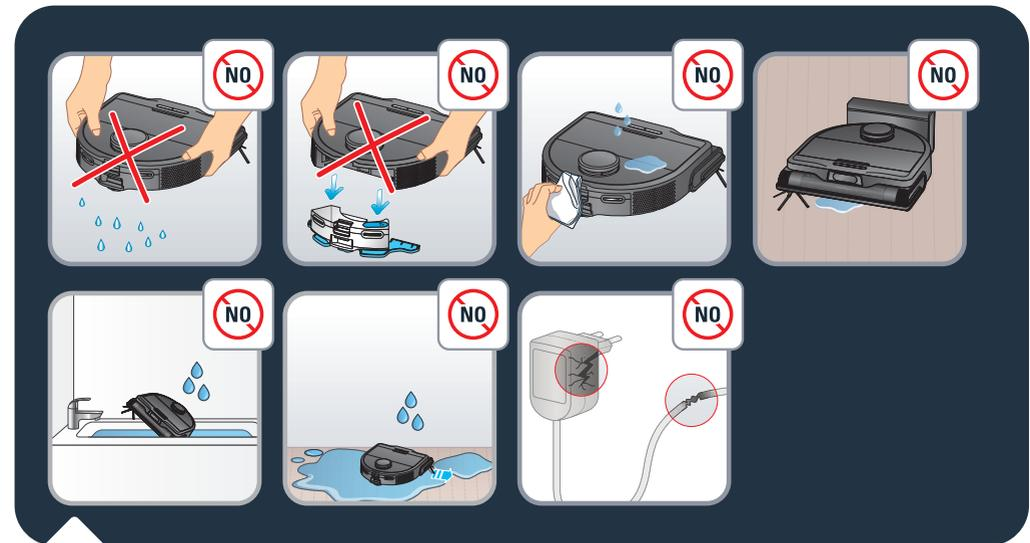
Schütteln Sie den Roboter nicht. Versuchen Sie nicht, die Halterung des vibrierenden Mopps vom Wasserbehälter zu trennen. Vermeiden Sie, dass der Roboter mit Wasser oder einem feuchten Tuch in Kontakt kommt. Laden Sie den Roboter nicht auf, wenn der Boden unter Wasser steht. Tauchen Sie den Roboter nicht unter Wasser. Verwenden Sie den Roboter nicht auf nassen Oberflächen oder auf Oberflächen mit stehendem Wasser.
