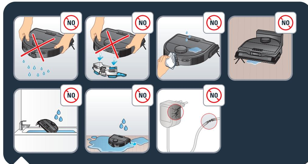
Nu scuturați robotul. Nu încercați să desprindeți suportul vibrator de mop de pe rezervorul de apă. Nu puneți apă sau cârpe ude pe robot. Nu încărcați robotul când solul este inundat. Nu scufundați robotul în apă. Nu folosiți robotul pe suprafețe ude sau pe suprafețe unde apa bălțește.
