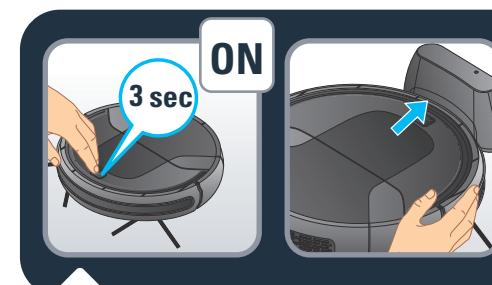
**RU** Чтобы зарядить робот, нажмите и удерживайте кнопку включения в течение 3 секунд. Поместите робот на зарядную станцию так, чтобы его контактные пластины касались клемм на зарядной станции.
