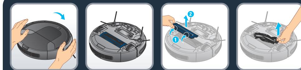
**RU** Очищайте щетку робота раз в неделю. Чтобы извлечь щетку, переверните робот, откройте защелки и выньте крышку щетки.
