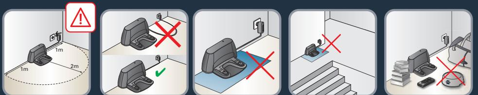
**RU** Устанавливая зарядную станцию, убедитесь, что с каждой стороны пустое пространство составляет 1 м и 2 м перед ней. Не устанавливайте зарядную станцию рядом с лестницей. Убедитесь, что кабель плотно вставлен в соответствующий разъем. Зарядная станция должна быть размещена на твердой поверхности. Не размещайте зарядную станцию на ковровых покрытиях.
