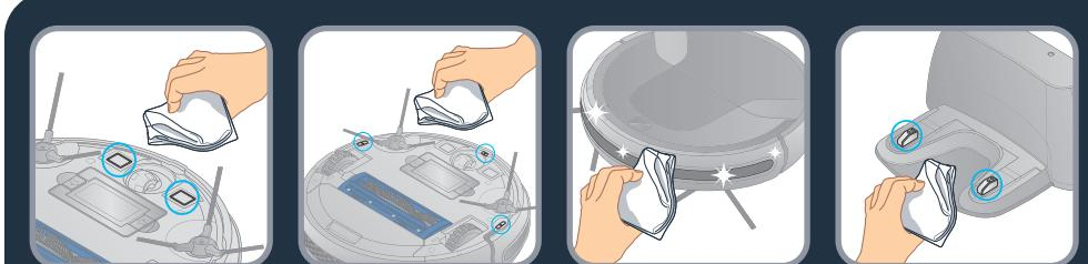
**RU** Очищайте следующие детали мягкой сухой тканью раз в неделю: контактные пластины робота, датчики падения, датчик расстояния и клеммы станции.
