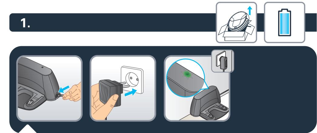
**RU** Подключите блок питания к разъему питания с боковой стороны зарядной станции. Используйте только входящее в комплект зарядное устройство: не пользуйтесь универсальными зарядными устройствами.
