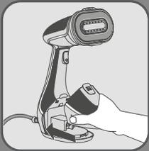
**ES** Vuelva a colocar el depósito de agua en su posición dentro del aparato. Asegúrese de que el depósito de agua está insertado completamente en su posición y bloqueado.
