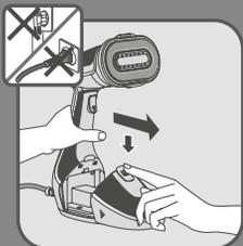
**DE** Stellen Sie sicher, dass das Gerät vom Stromnetz getrennt ist, und entnehmen Sie den Wasserbehälter.
