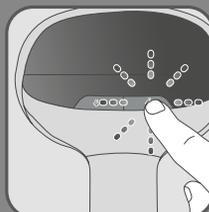
**DE** Modus „viel Dampf“: Für schwere Stoffe und zum Entfernen hartnäckiger Falten. Halten Sie die Taste zur Aktivierung des Boosts mehr als zwei Sekunden lang gedrückt. Der dreisekündige Boost kann maximal drei Mal pro Minute alle 20 Sekunden wiederholt werden.
