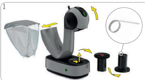
Compruebe que la bandeja de escurrido esté vacía. Retire el depósito de agua. Abra la manija de bloqueo. Retire e incline la bandeja de escurrido. Extraiga la aguja de limpieza de la herramienta de inyector. ¡Mantenga la aguja fuera del alcance de los niños!
