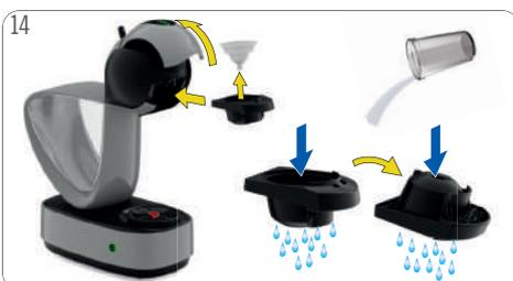
Abra la manija de bloqueo. Extraiga el soporte de la cápsula. Retire la herramienta de enjuague. Enjuague el soporte de la cápsula con agua potable fresca por ambos lados. Vuelva a insertar el porta cápsulas.
