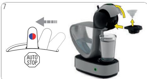
Espere hasta que la palanca se desplace a la posición "ALTO". Abra la manija de bloqueo. Extraiga el soporte de la cápsula. Retire la herramienta de enjuague. Vuelva a insertar el porta cápsulas.
