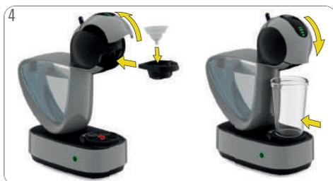
Abra la manija de bloqueo. Ponga la herramienta de enjuague dentro del soporte de la cápsula. Inserte el porta cápsulas en la máquina. Cierre la manija de bloqueo. Coloque un recipiente grande vacío debajo de la salida de café.
