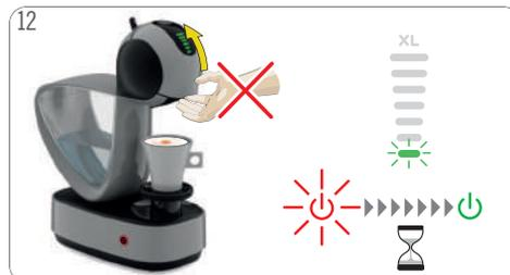
Después de terminar la preparación, el botón de encendido y las barras de nivel parpadean durante un máximo de 8 segundos. ¡No abra la manija de bloqueo durante este intervalo!
