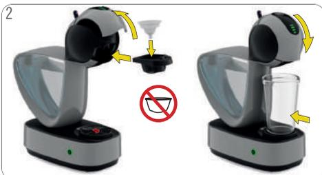
Abra la manija de bloqueo. Asegúrese de que la herramienta de enjuague esté en el porta cápsulas y que el porta cápsulas esté en la máquina. Cierre la manija de bloqueo. Coloque un recipiente grande vacío debajo de la salida de café.
