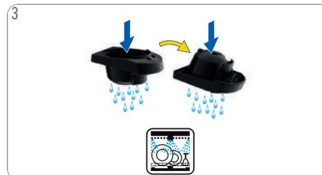
Limpie con líquido detergente y agua potable fresca ambos lados del soporte de la cápsula. Como alternativa puede lavarse en el lavavajillas. Séquelo a continuación.
