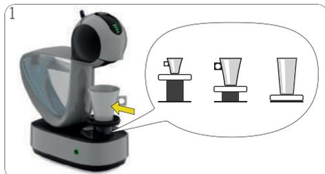
Para ajustar la posición de la bandeja de escurrido: Gire la bandeja de escurrido en sentido contrario a las manecillas del reloj para desbloquearla. Levántela hasta la posición deseada y bloquéela girándola en el sentido de las manecillas del reloj hasta que haga clic. La bandeja de escurrido está bloqueada.
