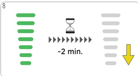
Para un mejor efecto del descalcificador, la máquina entra en un tiempo de espera de 2 minutos. Las barras de nivel bajan progresivamente de 7 a 0.
