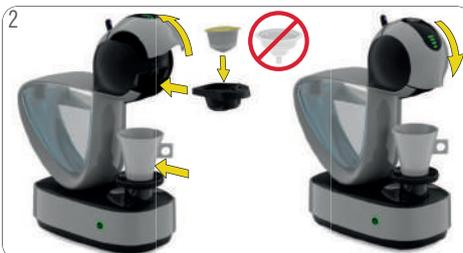
Vea el punto «EJEMPLOS DE BEBIDAS» o el paquete. Abra la manija de bloqueo. Extraiga el soporte de la cápsula. Asegúrese de que la herramienta de enjuague no esté dentro. Inserte la primera cápsula en el porta cápsulas. Insértelo de nuevo en la máquina. Cierre la manija de bloqueo. Coloque una taza del tamaño correcto sobre la bandeja de escurrido.
