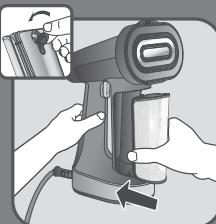
**SL** Vodni rezervoar znova namestite na mesto na napravi. Vodni rezervoar mora biti popolnoma nameščen.
