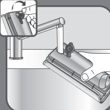
**SL** Odstranite zamašek za dovod vode, izperite posodo za vodo in jo napolnite z neobdelano vodo iz pipe.
