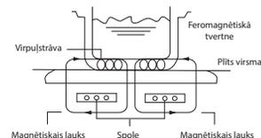
plūst ļoti zemas intensitātes Fuko strāvas. Neraugoties uz to nelielo intensitāti, šīs strāvas ģenerē siltumu traukā kad strāvas plūst caur to. Indukcijas karstās plīts darbības princips ir šo Fuko strāvu pavairošana, vienlaikus mainot ļoti augstas frekvences lauka virzienu, lai uzsildītu trauka apakšu. Uzkarsēšanas process ir tūlītējs, jo, tiklīdz tiek aktivizēts spoles strāvas avots, trauks tiek uzkarsēts. Tad ēdiens tiek uzkarsēts, saskaroties ar pannas pamatni.
