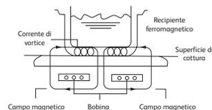
della bobina di induzione la pentola viene riscaldata. Gli alimenti vengono poi riscaldati entrando in contatto con il fondo della pentola. (vedere il capitolo Utensili di cottura).
