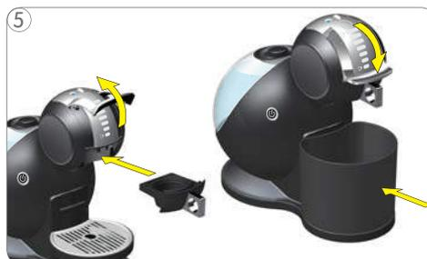
Levantar o manípulo e introduzir o porta-cápsula vazio (sem cápsula). Baixar o manípulo. Colocar o recipiente de cápsulas usadas por baixo do porta-cápsulas.
