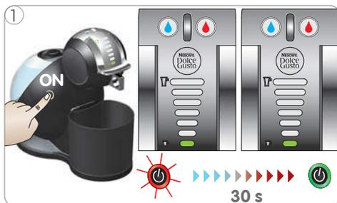
1 Ligar a máquina. Durante o aquecimento da máquina, o botão Ligar/Desligar pisca (vermelho). Após cerca de 30 segundos, o botão Ligar/Desligar acende (sem piscar) e a máquina está pronta para ser utilizada.
