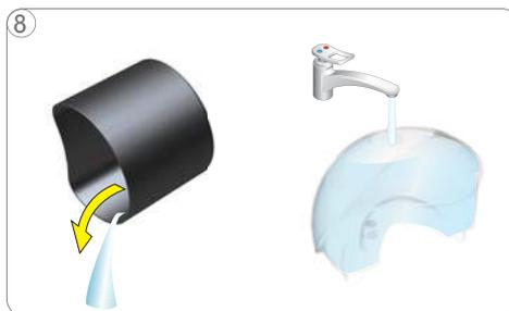
8 Esvaziar o recipiente de cápsulas usadas e encher o reservatório de água com água potável fresca.
