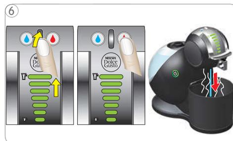
6 Enxaguamento da máquina: Acender todas as barras do visor até ao nível máximo com a roda selectora e premir o botão da água quente. A máquina inicia o ciclo de enxaguamento. As luzes no visor de barra apagam-se progressivamente.
