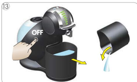
13 Aguardar até a máquina mudar novamente para o modo de operação normal. Depois, desligar a máquina. Retirar e esvaziar o recipiente de cápsulas usadas.
