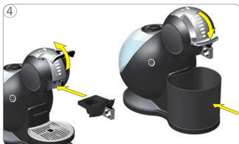
4 Levantar o manípulo e introduzir o porta-cápsula vazio (sem cápsula). Baixar o manípulo e colocar o recipiente de cápsulas usadas por baixo do porta-cápsulas.
