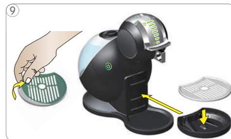
9 Retirar a película protectora da grelha da gaveta de recolha de pingos. Colocar a grelha na gaveta de recolha de pingos. Depois, instalar o conjunto na máquina.
