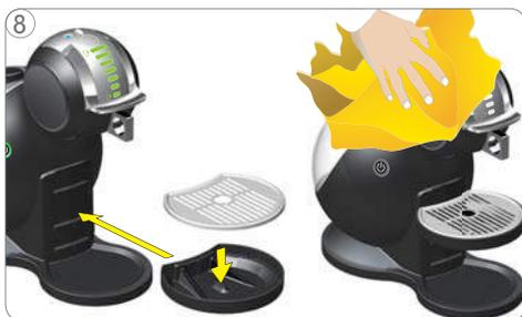
8 Colocar a grelha sobre a gaveta de recolha de pingos. Depois, instalar o conjunto montado na máquina. Limpar o exterior da máquina com um pano macio humedecido com água. Secar depois a máquina com um pano macio seco.
