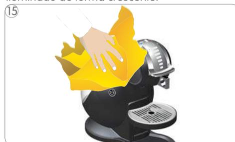
15 Colocar a gaveta de recolha de pingos. Limpar o exterior da máquina com um pano macio humedecido com água. Secar depois a máquina com um pano macio seco.
