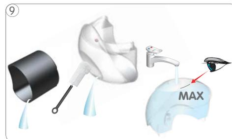
Esvaziar o recipiente de cápsulas. Lavar e enxaguar bem o reservatório de água. Encher o reservatório com água potável até ao nível máximo.
