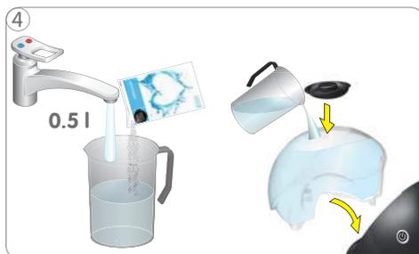
Misturar 0.5 litro de água potável com o conteúdo da saqueta de agente de descalcificação. Deitar a solução de descalcificação no reservatório de água e colocar o reservatório de água na máquina.
