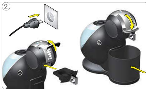
2 Levantar o manípulo e introduzir o porta-cápsula vazio (sem cápsula). Baixar o manípulo. Colocar o recipiente de cápsulas usadas por baixo do porta cápsulas. Ligar a ficha da máquina a uma tomada.
