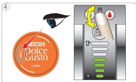
4 Utilizar a roda selectora para iluminar as barras de acordo com o número de barras indicado na cápsula (ou regular o visor de barra conforme a preferência do utilizador).
