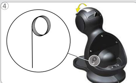
Retirar o reservatório de água e retirar a agulha de limpeza. Baixar o manípulo.
