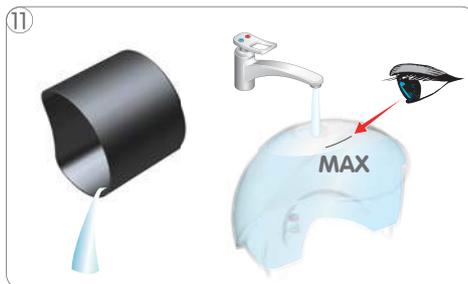
11 Esvaziar o recipiente de cápsulas usadas. Encher o reservatório com água potável até ao nível máximo.
