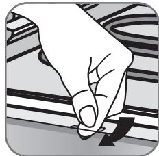
La vitre intérieure doit se soulever d'elle-même en partie inférieure pour une meilleure préhension. La déplacer vers l'intérieur du four pour la dégager de ses encoches de maintien. Retirez la vitre intérieure à la main et la nettoyer (à l'eau additionnée de détergent). Vous avez alors accès à la face intérieure de la vitre extérieure. La nettoyer avec une éponge humide (côté doux).
