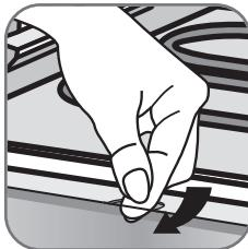
Die innere Scheibe sollte sich am unteren Ende selbst heben, damit sie sich besser greifen lässt. Schieben Sie sie in Richtung Ofeninneres, um sie aus den Halteaussparungen zu entfernen.
